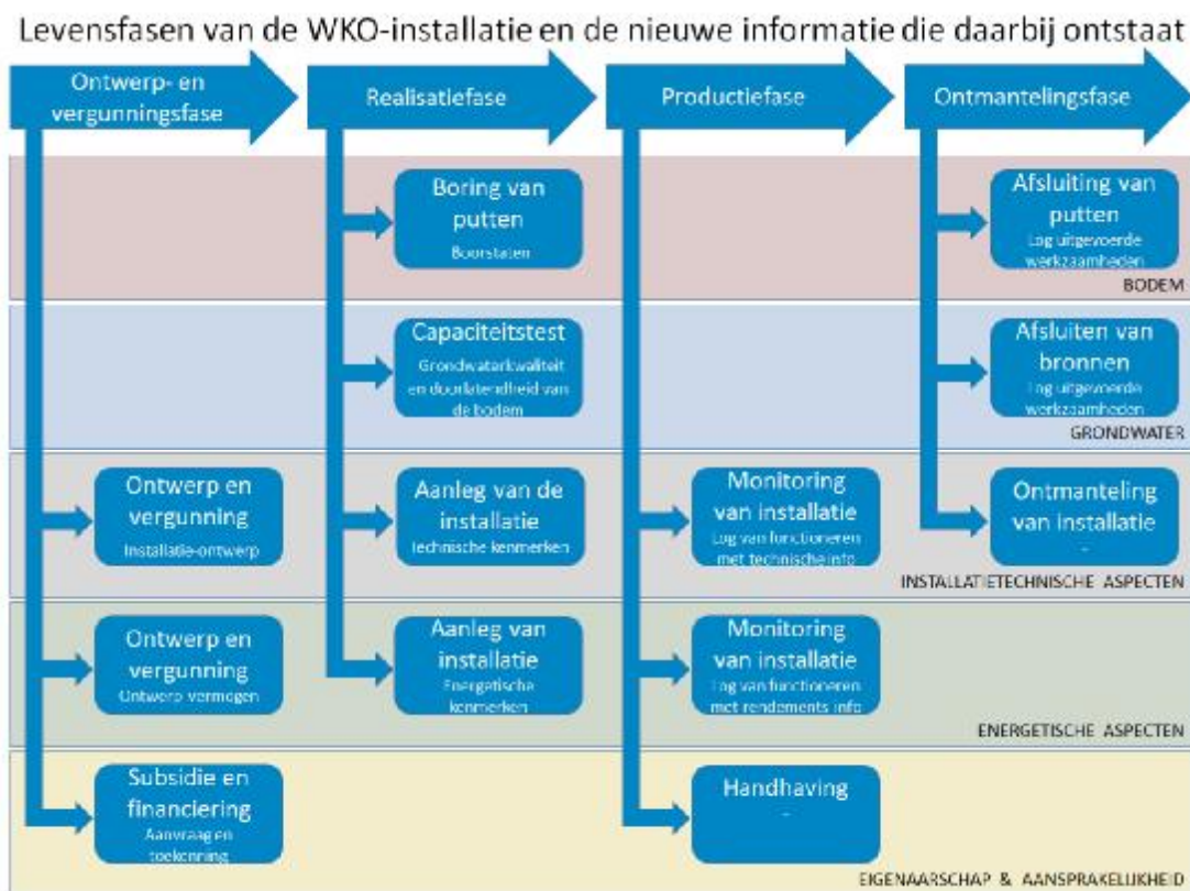
Figuur 2.2: De activiteiten waaruit nieuwe informatie ontstaat per levensfase van de WKO-installatie
