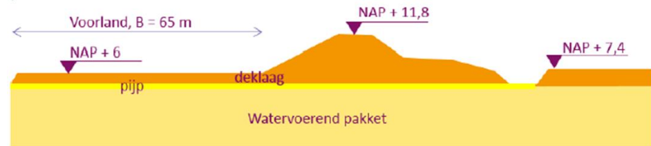
Figuur 6b: Schematisatie Scenario 1 met deklaag in voorland en potentiële ligging pijp onder dijkbasis en gehele voorland.
