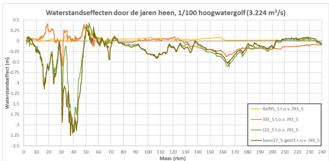
Figuur 5-1 Waterstandseffect door veranderingen in de riviergeometrie ten opzichte van 1993 (hoogwater T100 volgens WBI2017). De licht groene lijn toont het waterstandseffect van de 2021 situatie ten opzichte van de situatie in 1993 (uit De Jong et al., 2022).
