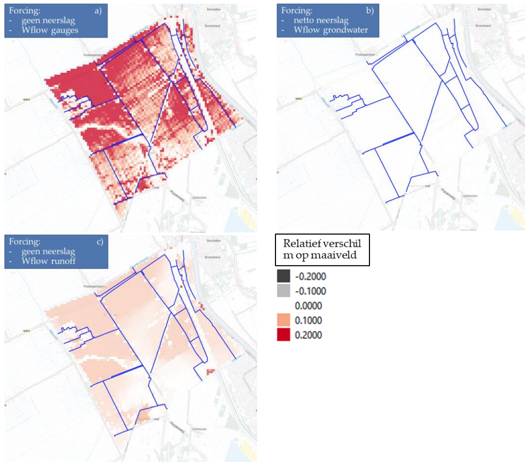
Fig. 9. Relatief verschil in maximale diepte per gridcel, vergeleken met het referentiemodel. Rood geeft aan dat waterdieptes in de referentieberekening groter waren, grijs dat deze bij de referentieberekening kleiner waren en wit geeft (bijna) geen verschil aan.
