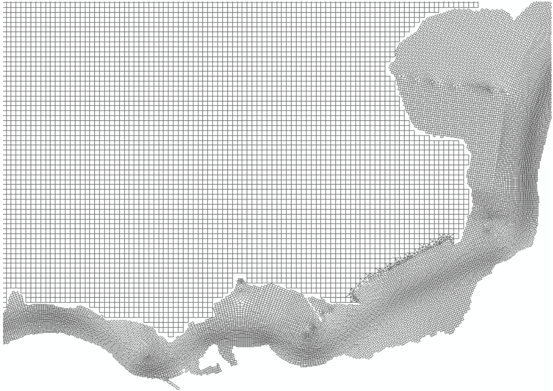
Fig. 54 Voorbeeld van gekoppeld riviergrid (curvilineair) met een cartesisch grid van het gebied. De bres wordt gesimuleerd op het gekoppelde gedeelte.
