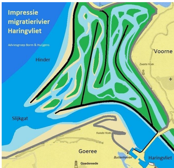
Figuur 3.14 Ontwerp voor een forse migratierivier met estuariene milieus van tientallen kilometers lengte tegen de kust gelegen op de Slikken van Voorne tussen de Maasvlakte en de monding van het Haringvliet. Deze 'gevouwen' variant kan worden uitgevoerd in uitgerekte vorm aan de zuidflank van de Maasvlaktes
