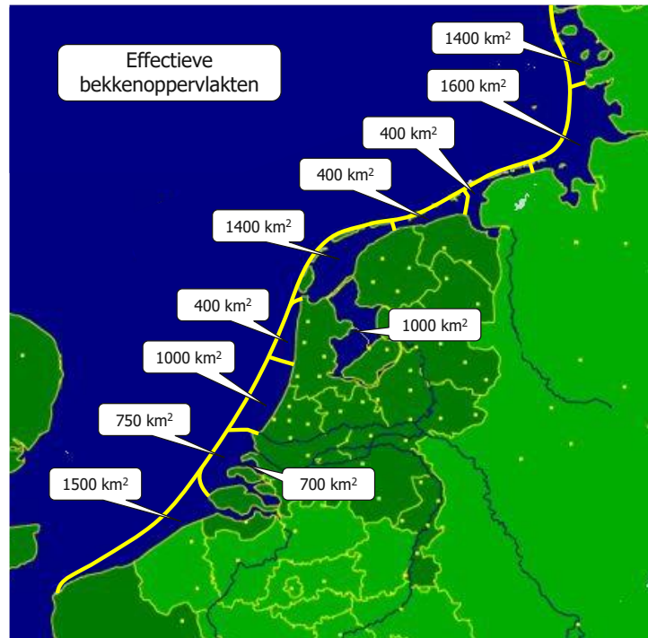
Figuur 7.1 Bekkenoppervlakten van Europese Zeedijk bij 25 km afstand tussen oude en nieuwe kust
