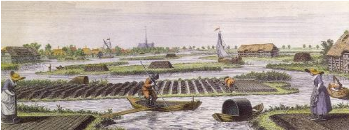
Figuur 3.13 Na winning van de bovenste veenlaag, ging men verder met het delven vanaf de waterbodems
