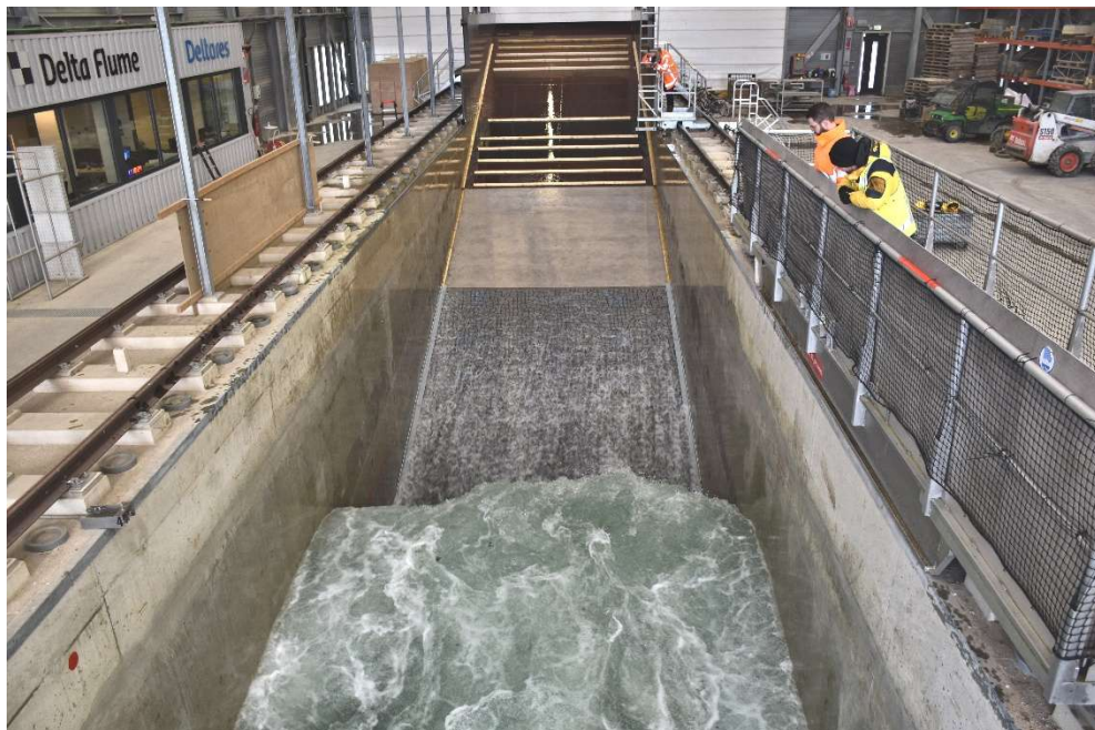
Golfbelasting in Deltagoot op talud met RONA ® ton XL
