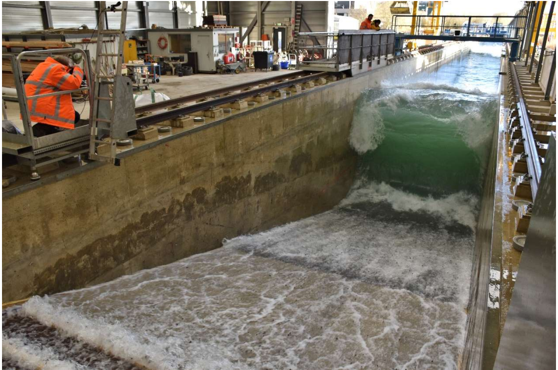
Figuur 4.3 Visuele waarnemingen tijdens de proeven werden bemoeilijkt door de heftige waterbeweging
