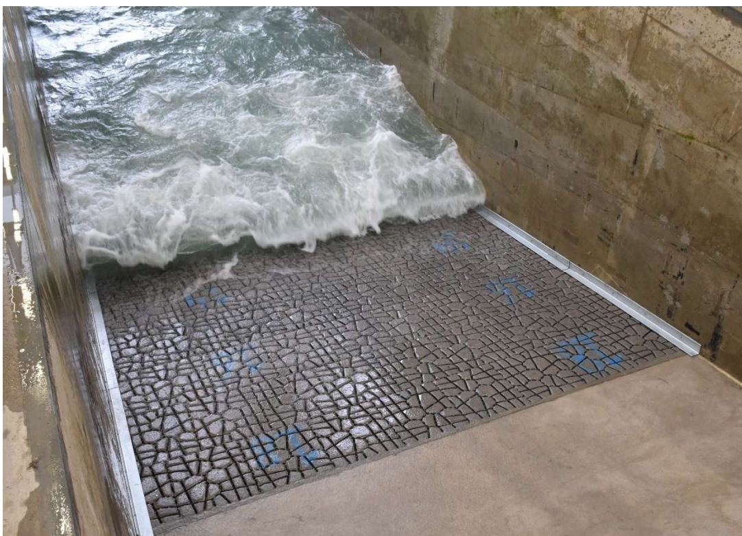
Figuur 4.1 Golfbelasting op talud met RONA®ton XL tijdens ingolfproef (proef RXL-01)
