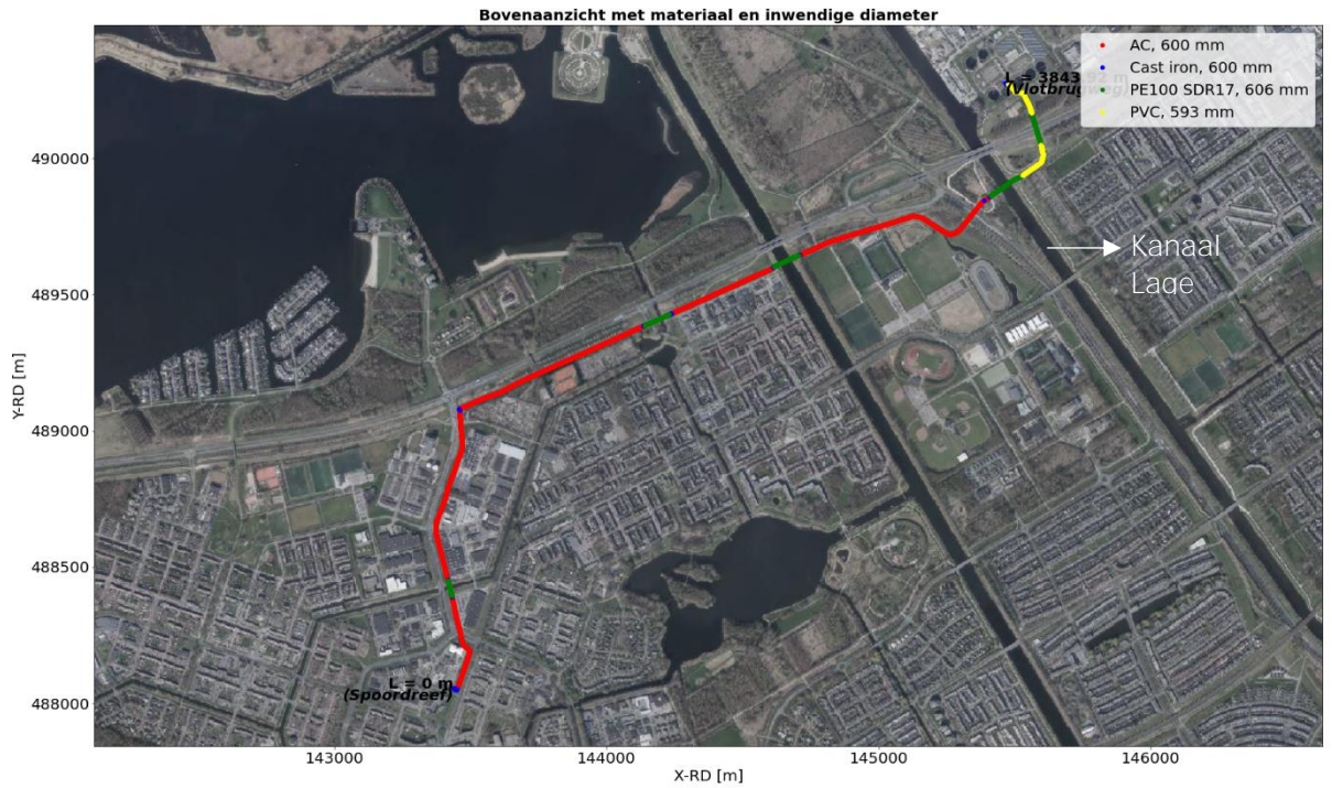
Figuur 7.4: Bovenaanzicht van verschillende leidingmaterialen bij persleidingtracé PL220 Almere.
