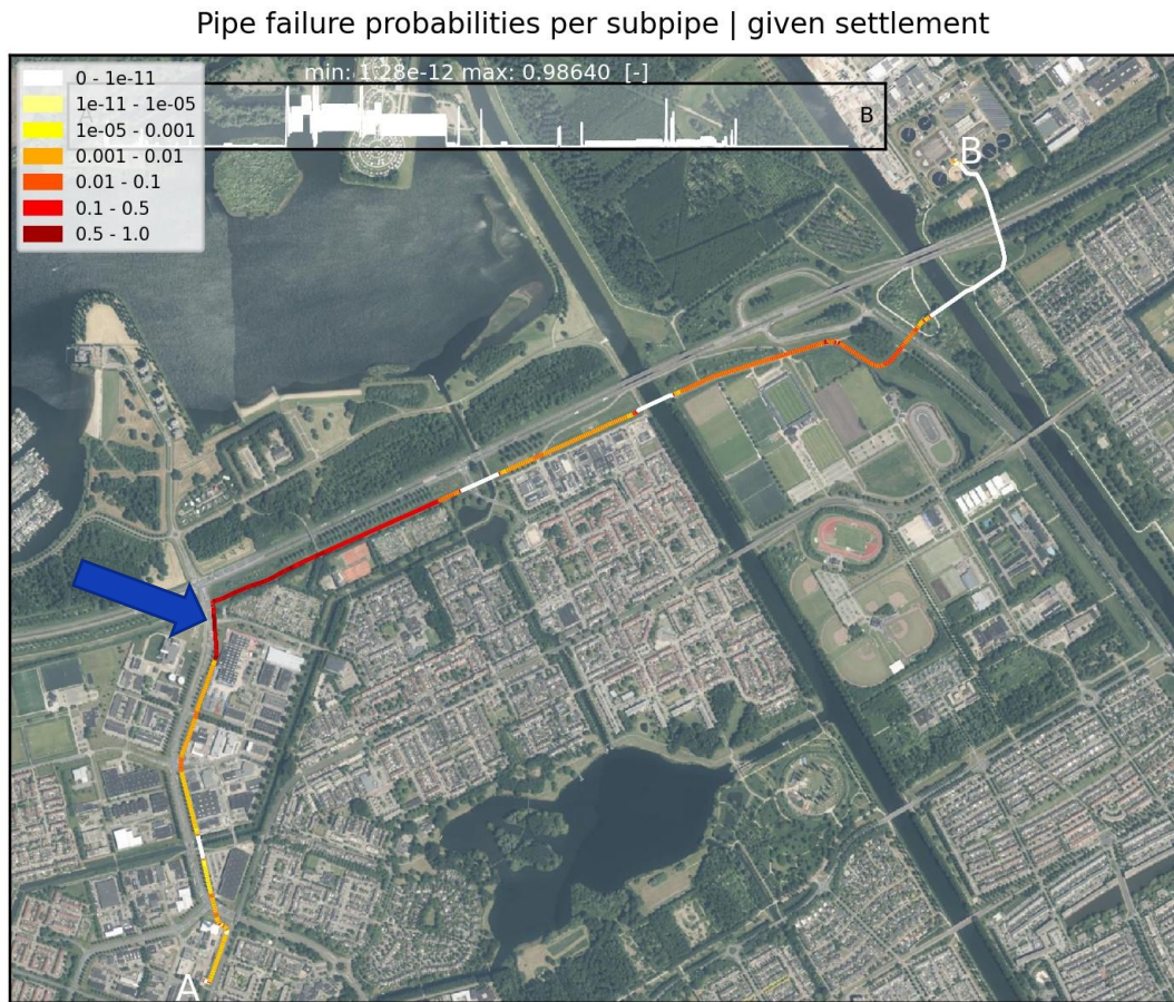
Figuur 7.23: Almere: faalkansen per meter leiding gegeven een zettingsverschil aanwezig ter plaatse van het leidingstukje in 2030.
