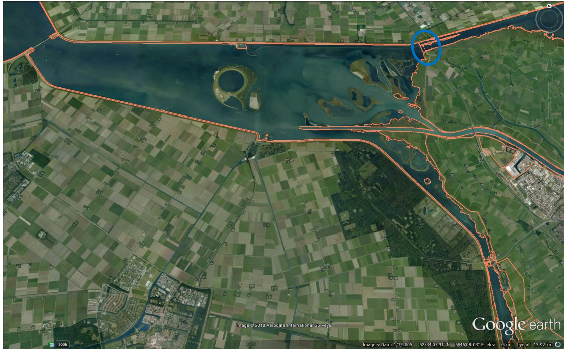
Figuur 3.4 Overgangsgedebied tussen IJsselmeer (links) en Ketelmeer (midden), Vossemeer - Drontermeer (rechtsonder) en Ramsdiep - Zwarte Meer (rechtsboven) in Google Earth. Deze uitsnede is geel omkaderd in Figuur 3.1. De scheiding tussen Ketelmeer en Ramsdiep (vaargeul, noordkant) en Ramsgeul (zuidkant) wordt gevormd door de Ramspolkering (blauwe ellips). De oranje lijnen zijn de winterdijk en de oeverlijn uit de laatste versie in Baseline voor dit gebied.
