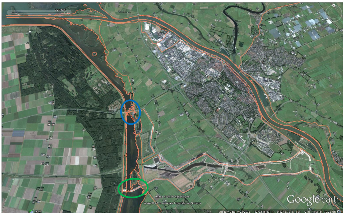
Figuur 3.5 Gebied rondom de nieuwe bypass bij Kampen met Drontermeer (linksonder), Vossemeer (linksboven) en de IJssel (rechts) in Google Earth. Deze uitsnede is blauw omkaderd in Figuur 3.1. De oude scheiding tussen Drontermeer en Vossemeer is de Roggebotsluis (blauwe ellips). De nieuwe scheiding wordt gevormd door de Reevesluis en de Reevedam (groene ellips). De oranje lijnen zijn de winterdijk en de oeverlijn uit de laatste versie in Baseline voor dit gebied.
