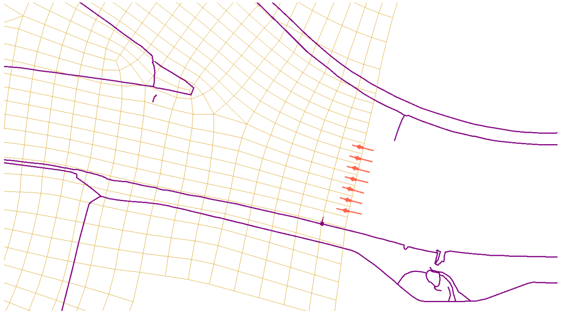
Figuur 4.27 Locaties van bron-/puttermen (oranje lijnstukjes) in rooster (gele driehoeken) voor modelleren in-/uitstroom IJssel in Ketelmeer (in paars de zogenaamde “fixed weirs” zoals weergegeven in Delta Shell).
