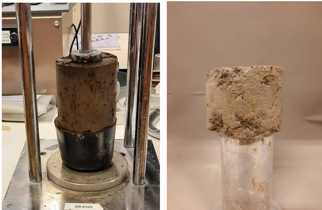
Figuur 5.5 Monster Pk1.1_1 voor (links) en na (rechts) van de erosieproef.
