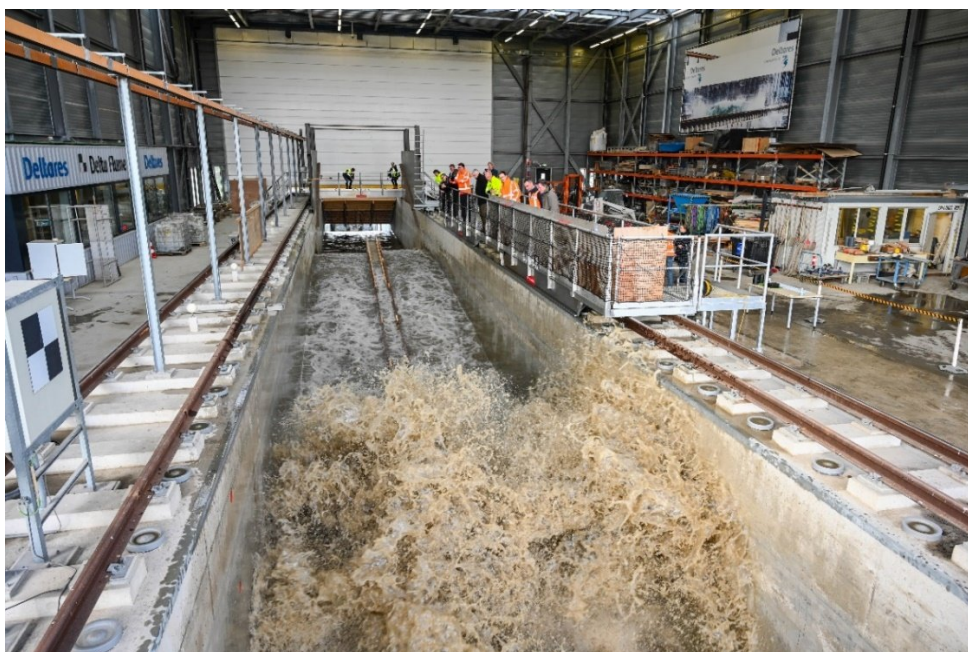
Figuur 1.2, Golfbelasting op het kleitalud in de Deltagoot.
