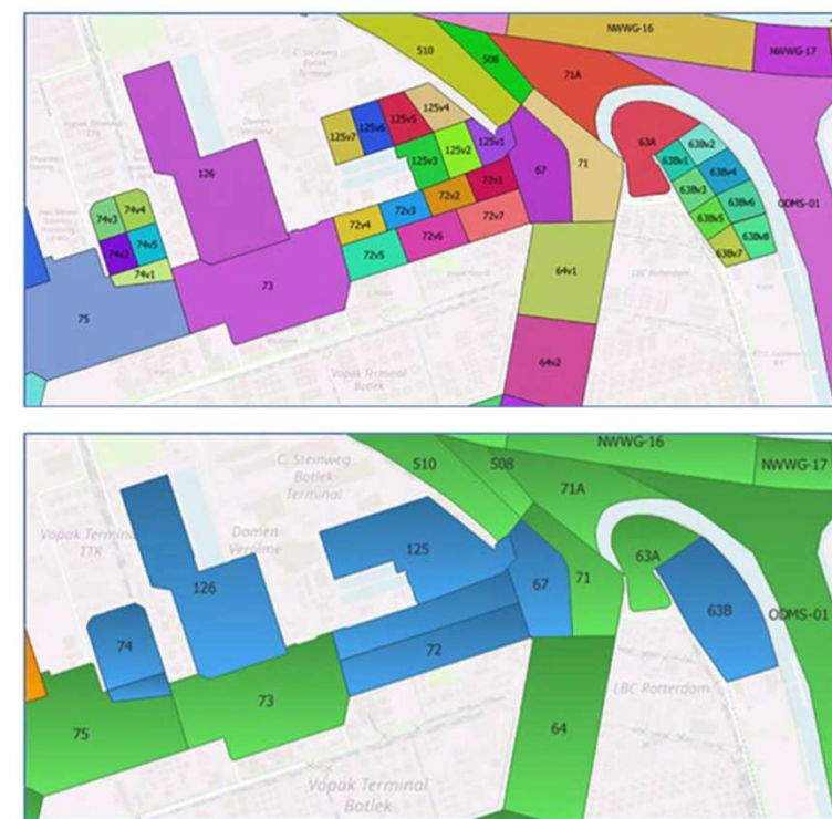
Verskil in resolutie van de data tussen de gegevens van milieukwaliteit (boven) en baggervakken (onder) in de Rotterdamse haven.
