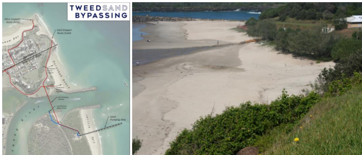
Figuur 3-11 Weergave van de Tweed River sediment bypass in Australië, met de layout van het persleidingsysteem (links) en de voedingslocatie op het strand (rechts). Bron: https://www.tweedsandbypass.nsw.gov.au/
