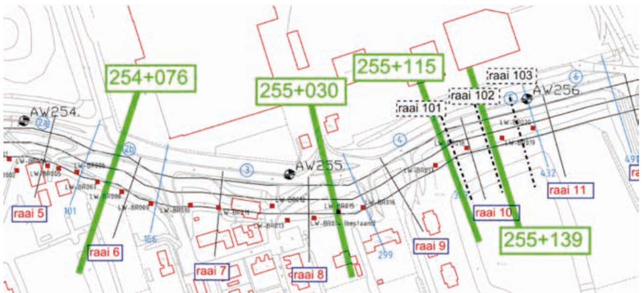
Figuur 9.4 Overzicht vakindelingen (blauw omcirkelde getallen), positie raaien (zwarte lijnen) en maatgevende dwarsprofielen (groene lijnen). De rode puntjes stellen de bronnen voor
