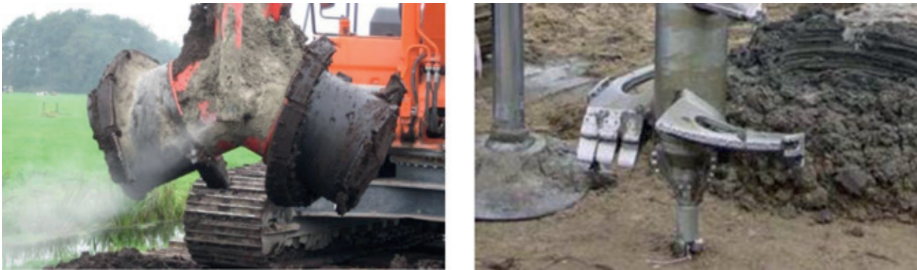
Figuur 5.3 Mengwerktuig massastabilisatie en kolomstabilisatie
