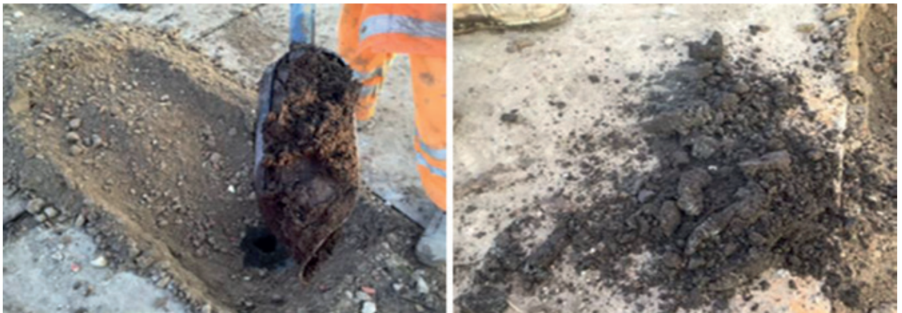
Figuur 5.5 Stabilisatie gedraagt zich na opboren granulair
