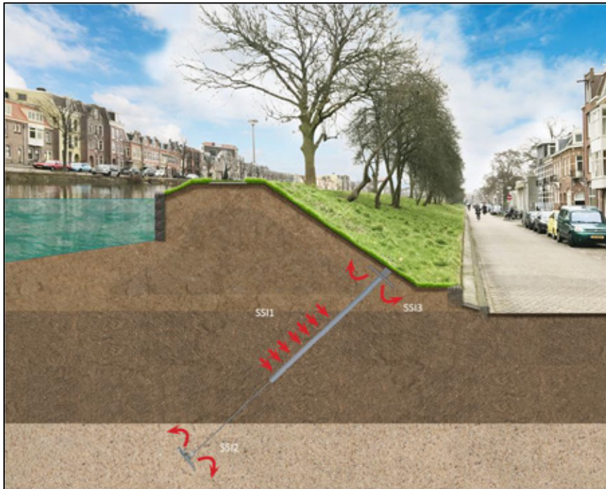
Figuur 6.4 Deelfaalmechanismen JLD-Dijkstabilisator grond-constructie-interactie
