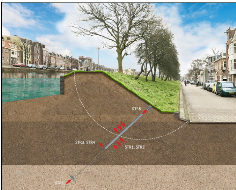
Figuur 6.3 Deelfaalmechanismen JLD-Dijkstabilisator constructief falen
