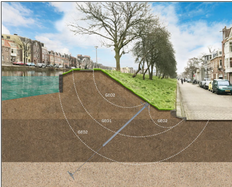
Figuur 6.2 Deelfaalmechanismen JLD-Dijkstabilisator geotechnisch falen
