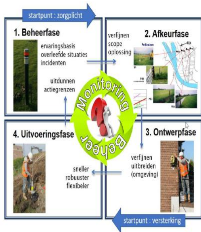
Figuur 9.1 Life cycle monitoring: doorgifte van data en anticipatie gedurende een voortdurende, decennialange cyclus
