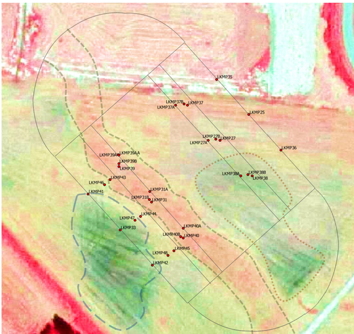
Figuur 5.8 Bovenaanzicht van infrarood satellietbeeld (blauw omlind de natte plek ter plaatse van de groene dijk, in groen de plaats van voorbelaste gedeelte door oude zomerkade, in bruin gestippeld een andere natte plek op het terrein)
