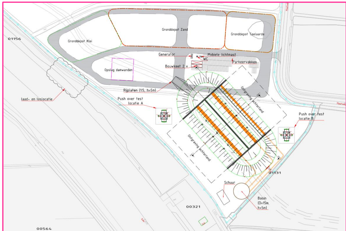
Figuur E.3 Bovenaanzicht proefterrein inclusief aan te leggen ringdijk ten behoeve van full-scale proeven
