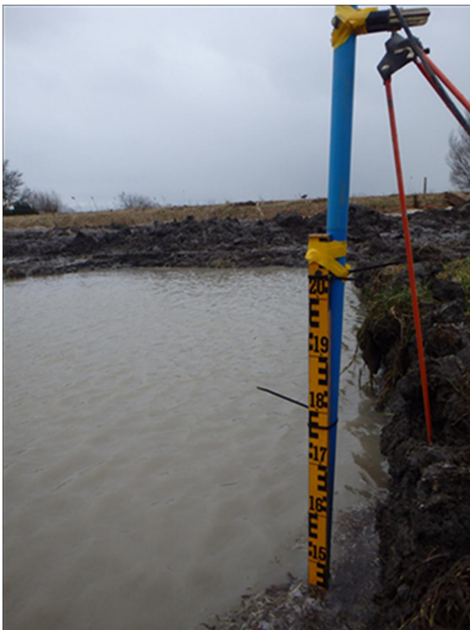
Foto 3.6 Peilschaal gemonteerd op BH FWZGMI met bovenkant op NAP + 0,37m (slag 3)
