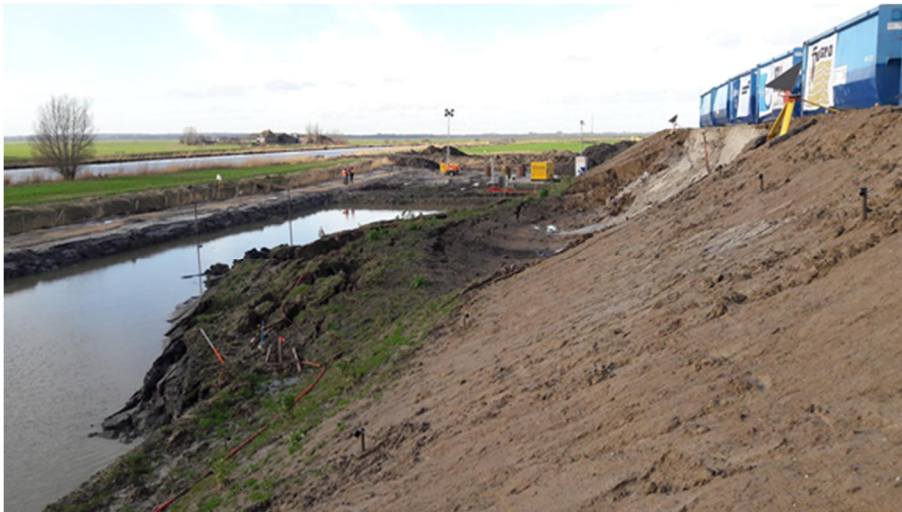
Foto 3.30 Doorgaande vervorming ondiep glijdvak bij groene proefdijk
