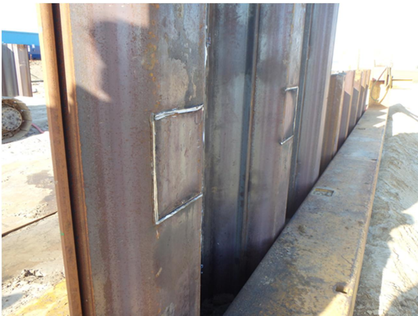
Foto 4.7 Vooraanzicht geïnstrumenteerde damwandplan na verwijderen verstijvingsplaat
