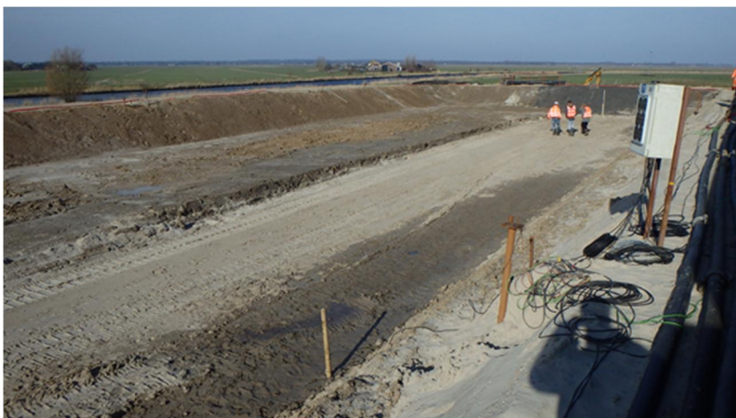
Foto 4.13 Natte plekken op bodem waterbassin bij infiltratie zandkern dijk tot NAP +3,20m (stap 6)
