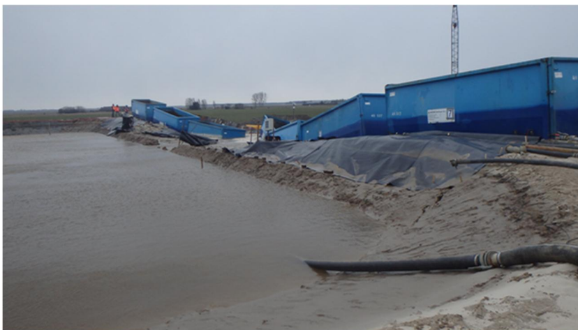
Foto 4.33 Bezwijken blauwe proefdijk; overslaand water vanuit waterbassin (boven zuid)
