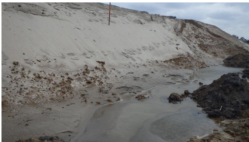
Foto 4.23 Visuele controle van bezwijkvlak groene dijk ivm oplopen waterpeil in zandkern (onder)
