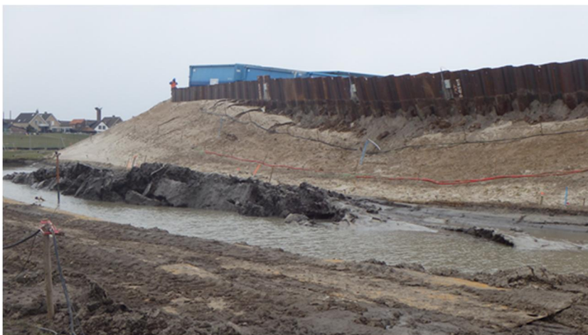
Foto 4.30 Bezwijken blauwe proefdijk; ontwikkeld glijdvlak binnentalud
