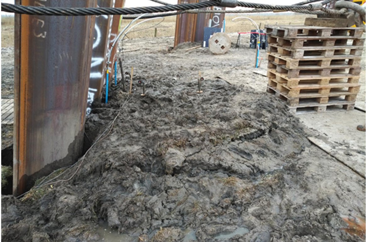
Afbeelding 3.7 : Vervormingen AZ26-700 na afloop proef (2)
