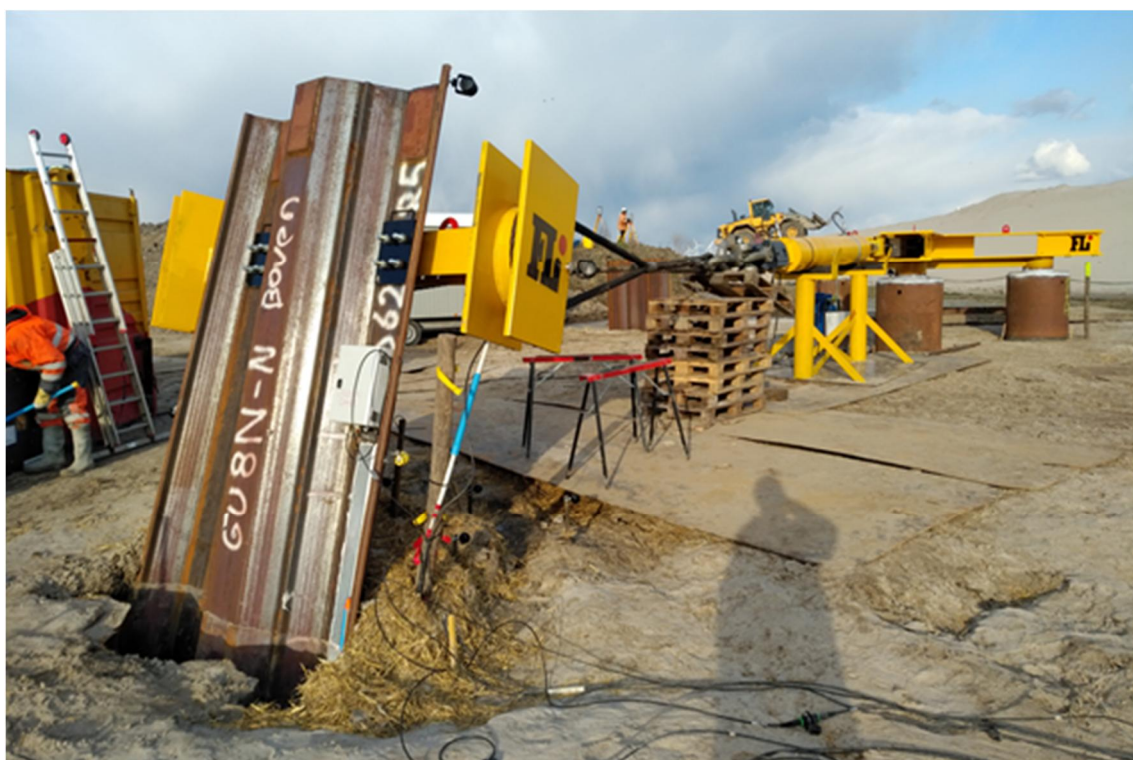
Afbeelding 3.3 : Vervormingen GU8N na afloop proef (1)
