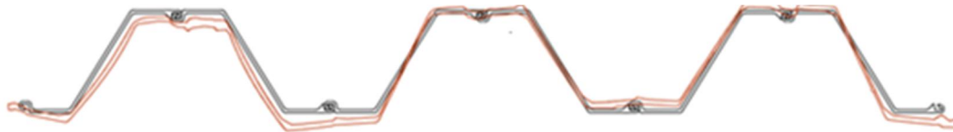
3D-scan van AZ26 configuratie na afloop (dwarsdoorsnede op ca. NAP -3,3m)
