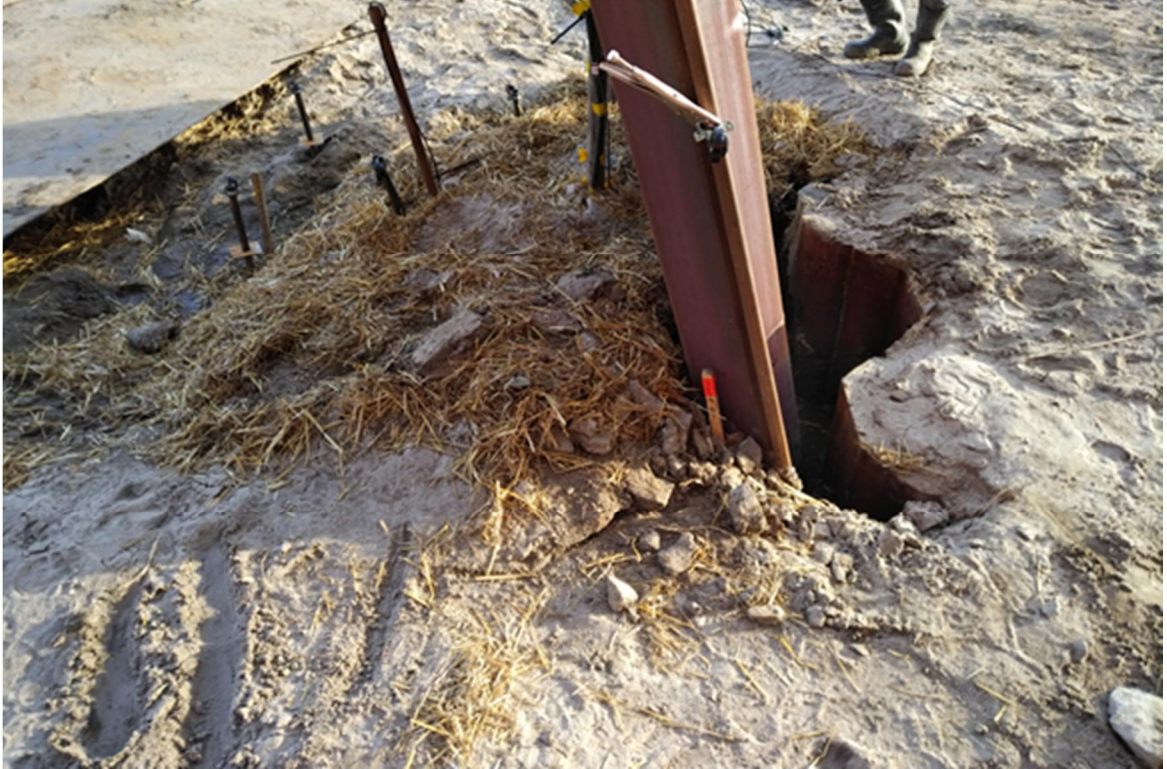
Afbeelding 3.4 : Vervormingen GU8N na afloop proef (2)
