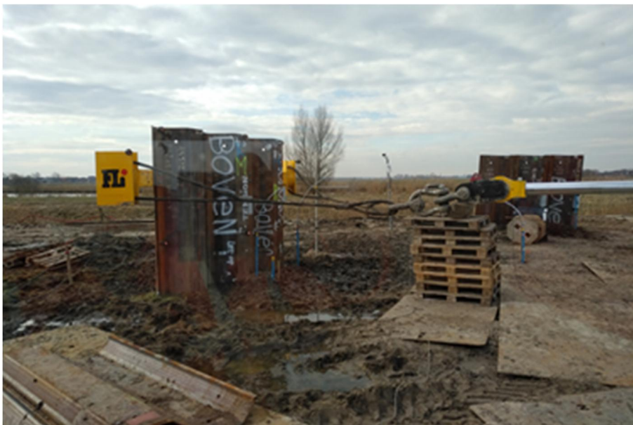
Afbeelding 2.8: Ondersteuning schakels met pallets (AZ26-700)
