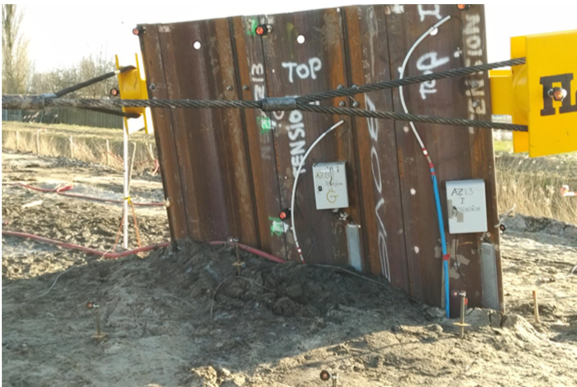
Afbeelding 3.1 : Vervormingen AZ13-700 na afloop proef (1)
