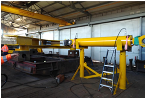
Afbeelding 2.4: Links frame met vijzel, rechts gording HEB240
