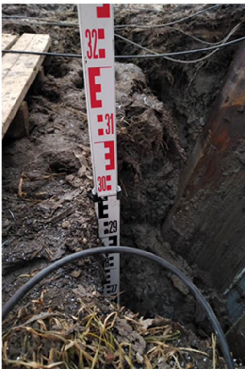
Afbeelding 3.6 : Vervormingen AZ26-700 na afloop proef (2)
