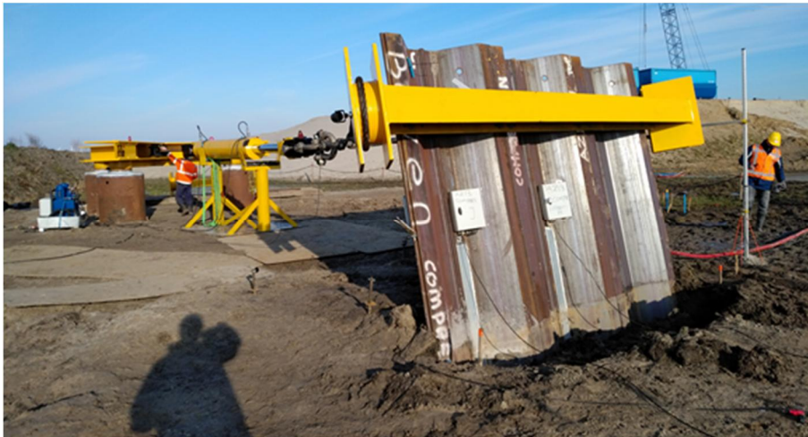
Figuur 3.14 Vervormd profiel na afloop proef drie dubbele AZ13-700
