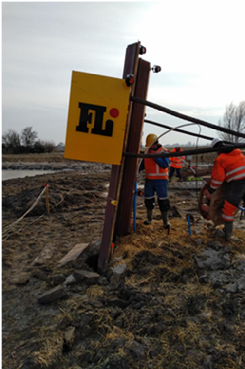
Figuur 3.22 Vervormd profiel na afloop proef GU8N-rev-triplet
