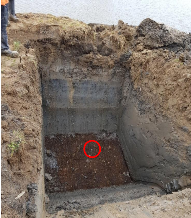
Foto C.3.2 Opgegraven kleistaaf op bekende GPS locatie (kleistaaf aangeduid met rode cirkel). Gat is ontgraven tot op bovenzijde veenlaag op ca. NAP -2 m
