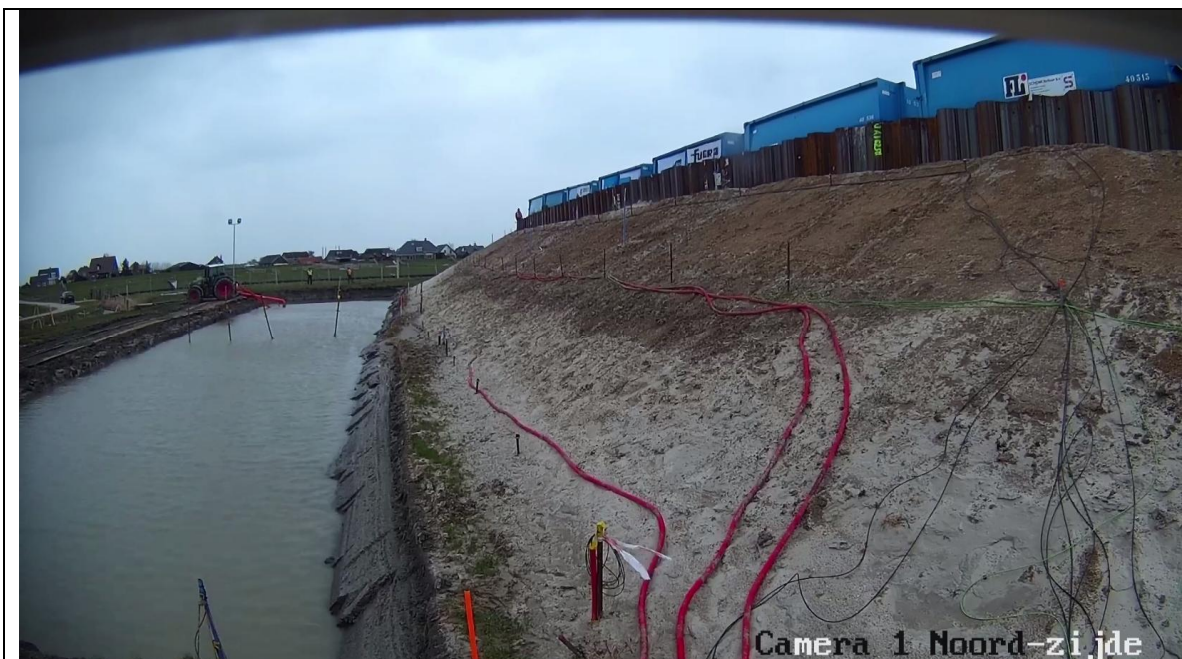
5 sec: Doorgaande vervorming van de zakbakens maar ook het talud zakt, de containers achter de damwanden zakken en de damwand komt iets naar voren.
