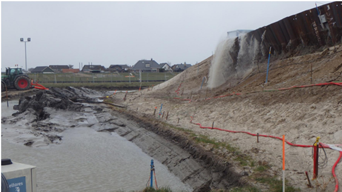
Figuur 0.1 Full-Scale Proef op dijk versterkt met onverankerde doorgaande stalen damwand
