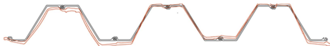
Figuur 3.30 3D-scan van AZ26 configuratie na afloop (dwarsdoorsnede op ca. NAP -3,3 m)
