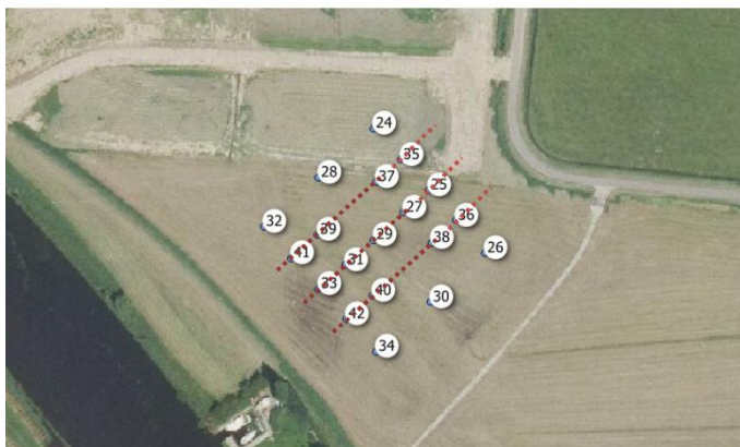
Figuur C.4.3 De locatie van de zettingsmeetslangen, die zijn 'onderbroken' om ruimte te maken voor de latere installatie van de damwand van locatie 37 naar 27 naar 38
