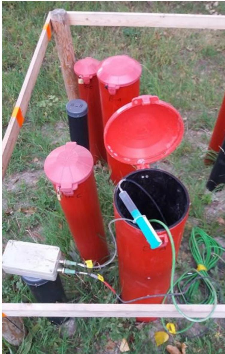
Figuur 3.9: Vacuümbehandeling van een Fugro WSM met gasfilter m.b.v. een injectiespuit.
