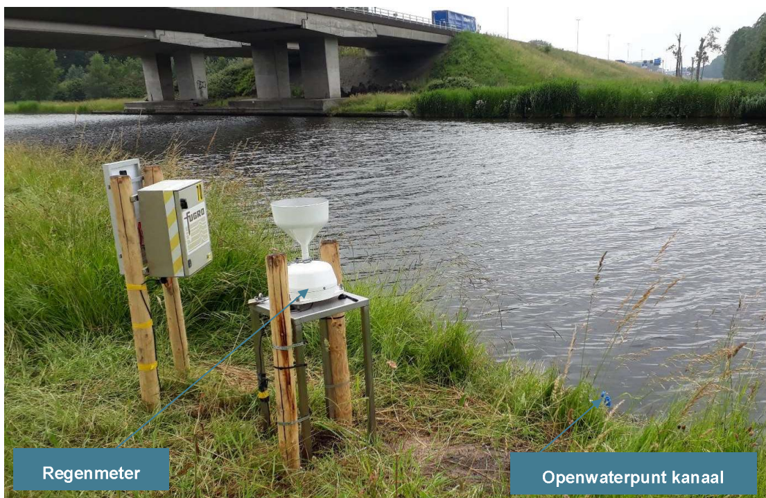
Figuur 2-4: Openwatermeetpunt kanaal en regenmeter
