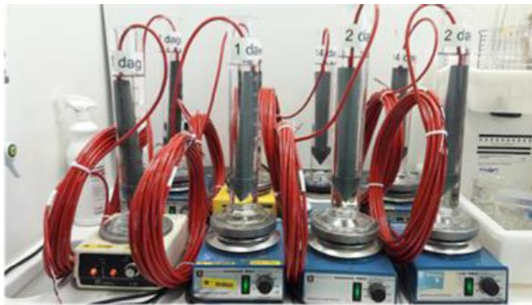
Figuur 2.3: Opstelling van test werkingduur (laagje) gel aangebracht in Geopoints.
