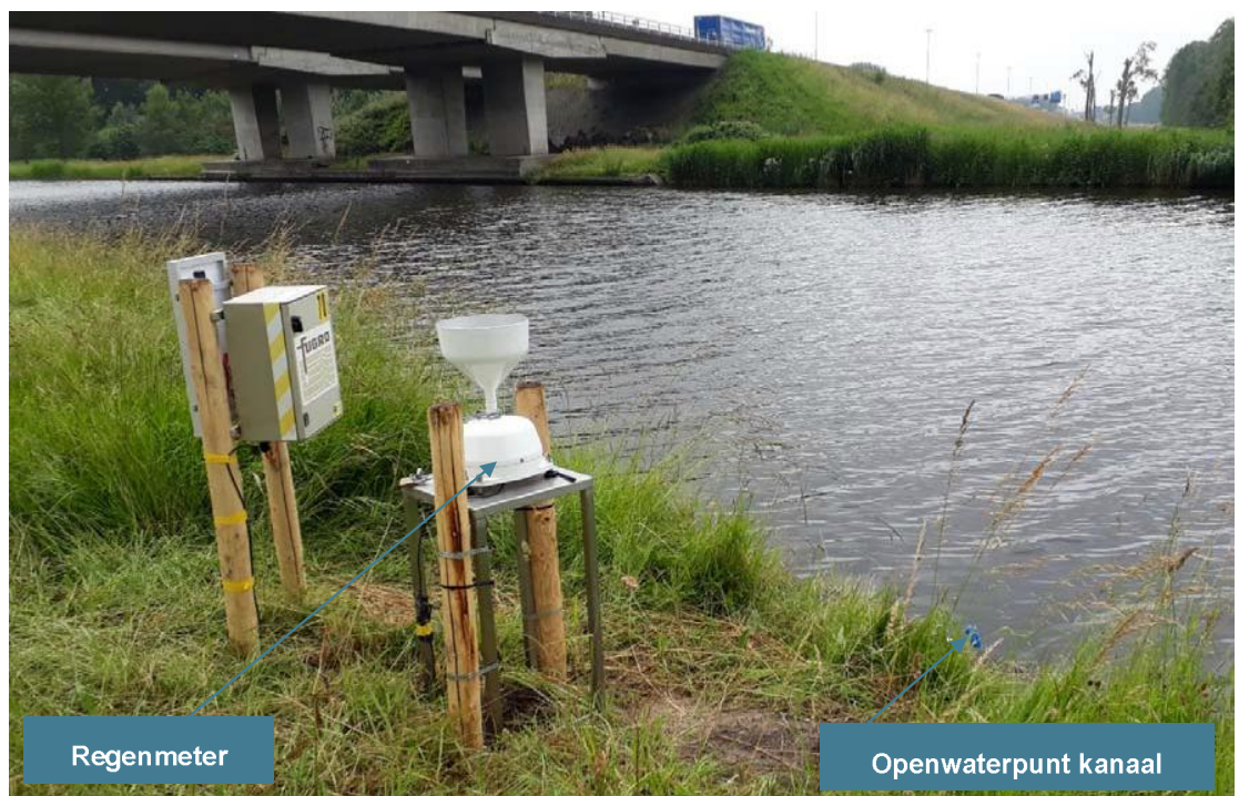
Figuur 2-4: Openwatermeetpunt kanaal en regenmeter
