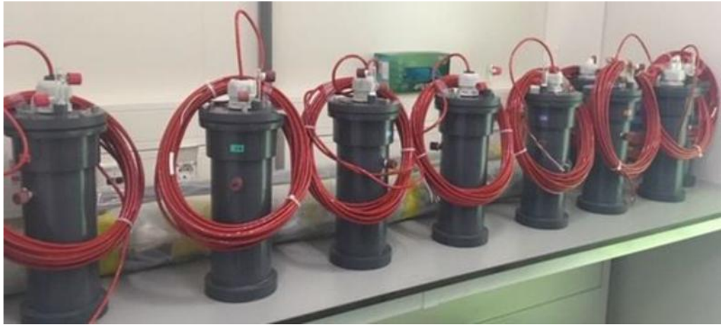
Figuur 2.5: Opstelling van kolommen met grond, grondwater en Geopoints om de werkingduur van de gelpellet uit te testen bij 12°C.
