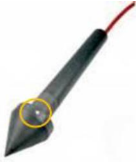
Figuur 2.2: Geopoint met een van de vier filters (oranje omcirkeld), die gelijkmatig rondom verdeeld zijn (foto Eijkelkamp).
