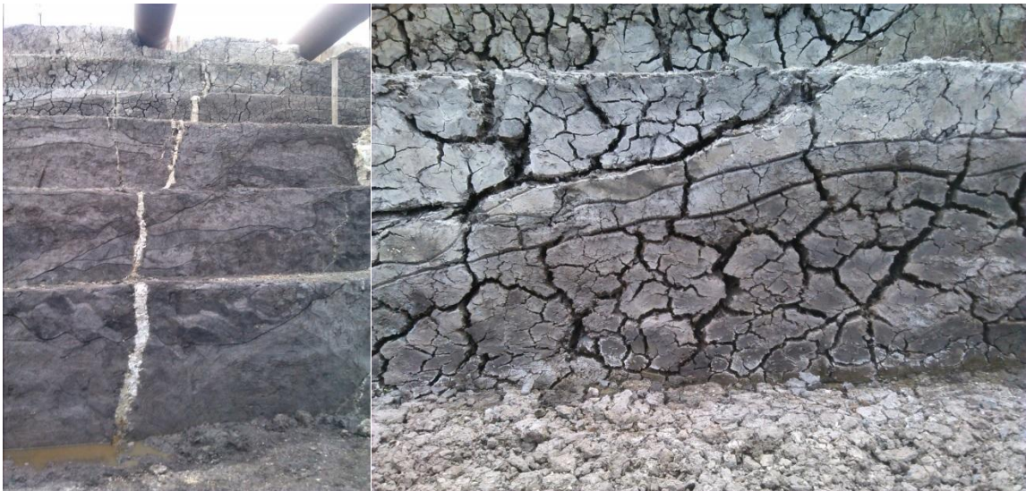
Figuur D.3 Voorbeeld gescheurd dijk materiaal na ontgraven. Waarschijnlijk is de scheurvorming ontstaan als gevolg van het ontgraven en uitdrogen
