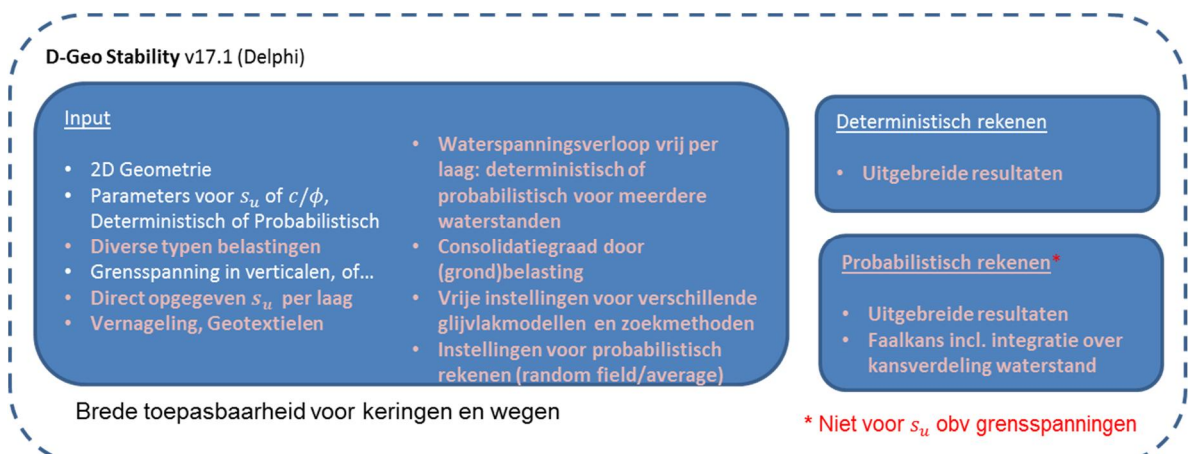
Figuur 2.3 Overzicht van de functionaliteit van D-Geo Stability voor glijvlakberekeningen op doorsnedeniveau. De extra functionaliteit ten opzichte van BM-Macrostablieit is roze gekleurd. De Delphi versie van D-Geo Stability zal niet verder worden doorontwikkeld.
