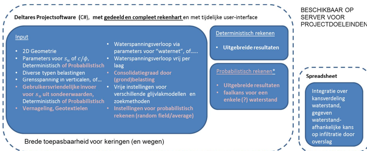
Figuur 3.4 Overzicht van de beoogde functionaliteit van de projectsoftware voor glijvlakberekeningen op doorsnedeniveau. De extra functionaliteit ten opzichte van de oude versie is roze gekleurd.
