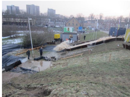
Figuur E.1 Proefbelasting erosie met de 4 m brede golfoverslagsimulator (links op de dijk bij Millingen, rechts op de dijk bij Nijmegen)
