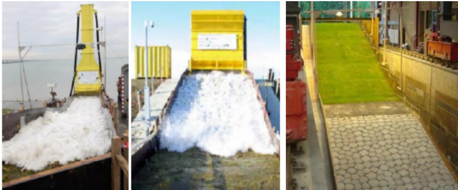
Figuur H.6 Impressie van de golfoploosimulator (links), de golfoverslagsimulator (midden) en de Deltagoot (rechts)
