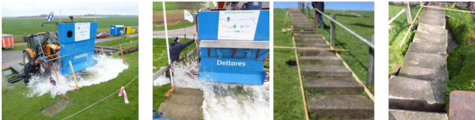
Figuur 5.6 Impressie van test met golfklapgenerator op een trap. Tijdens de testen bleek dat er rondom de trap een laag zand zat welke snel uitspoelde ([41])
