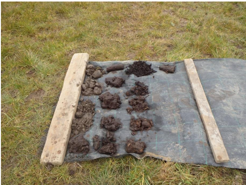
Figuur 4.5 De uitkomende grond wordt op een boorkleed per 20 cm uitgelegd
