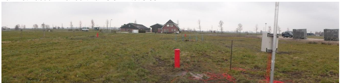
Figuur 4.11 Hellingmeetbuis en aansluitkast voor de waterspanningsmeters
