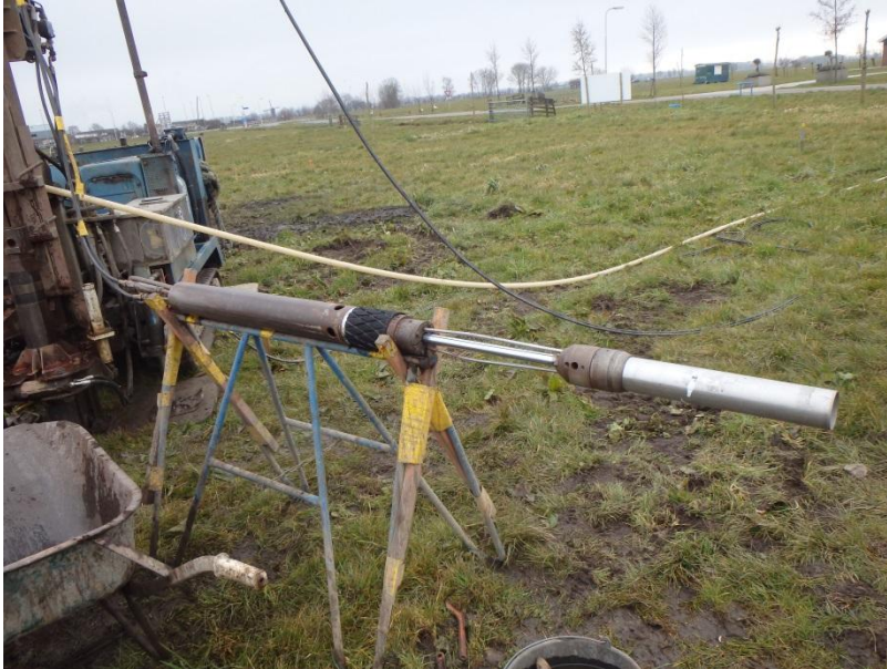
Figuur 4.6 Steekapparaat waarmee de Ackermann busen hydraulisch gestoken worden
