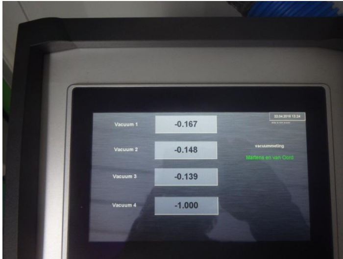
Figuur 3.10 De vacuümdruk wordt digitaal uitgelezen
