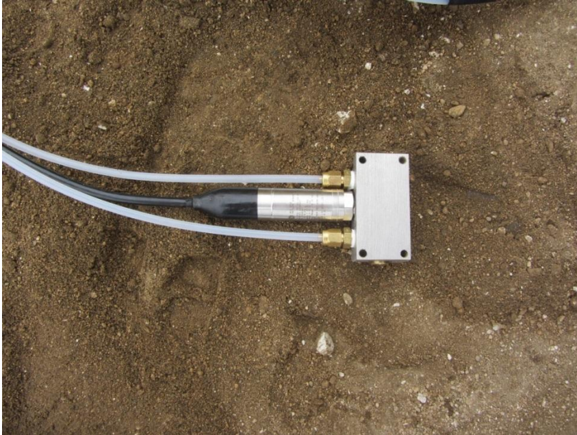
Figuur 4.1 Zettingsmeetinstrument. Het afgesloten vierkante aluminium bakje wordt gevuld via de twee kunststof leidingen. Het bakje is gekoppeld aan een referentiebak met een constante waterdruk. De waterspanningsmeter op het bakje (tussen de slangen) is aangesloten op een loggerkast en kan online worden uitgelezen
