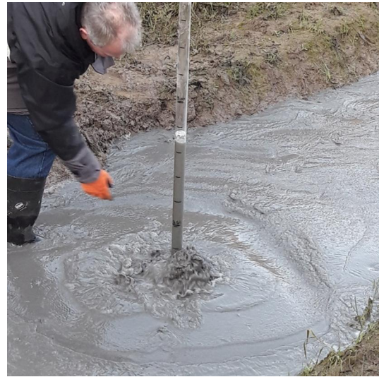
Tijdens proef. Onderkant peilbuis ter hoogte zandpakket
