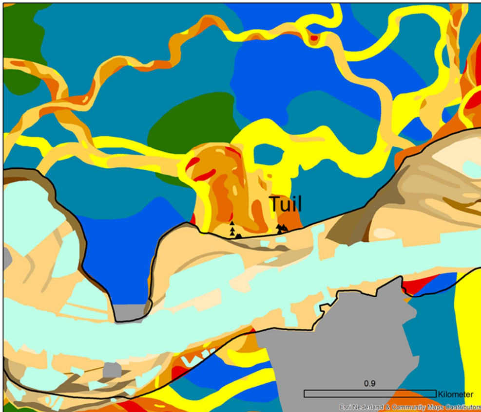
Figuur B.4 Zandmeevoerende wellen bij Tuil, geconcentreerd waar de deklaag het dunst is
