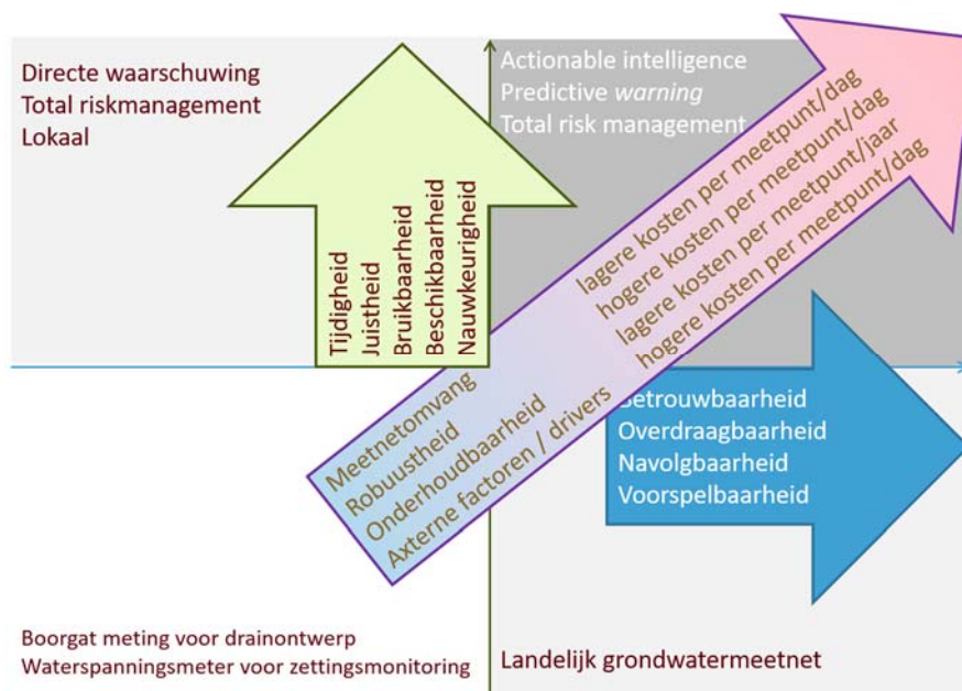
Figuur 6.2 Van laagwaardige karakterisatie waar meetfrequentie en meetnetdichtheid niet zwaar wegen, tot droomsituatie voor hoogwaardige risicobeheersing, met veel permanente metingen met korte tijd tussen meting en presentatie, waarin er nooit een tekort aan gegevens is.
