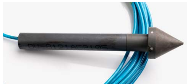
Figuur 3. Waterspanningsmeter met 4 kunststof grondfiltertjes (witte stippen) In de schouder achter de punt.
