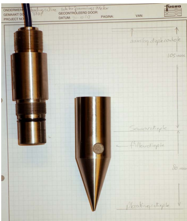
Figuur 3, Componenten Geokon waterspanningsmeter.
