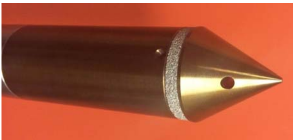
Figuur 2, Waterspanningsmeter met 150µm gesinterd stalen grondfilter.
