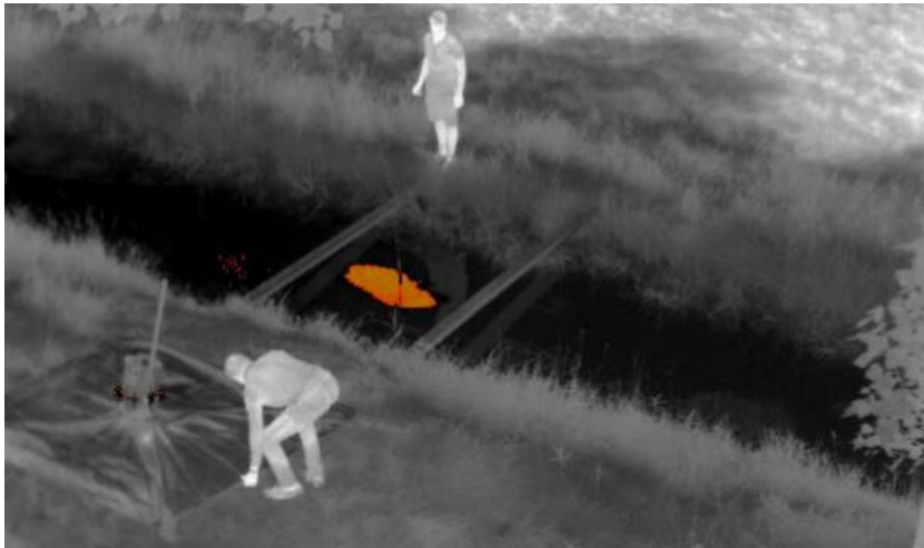
Figuur 3; Na het vinden van de meest actieve wel wordt het debiet bepaald van het uitstromende kwelwater
