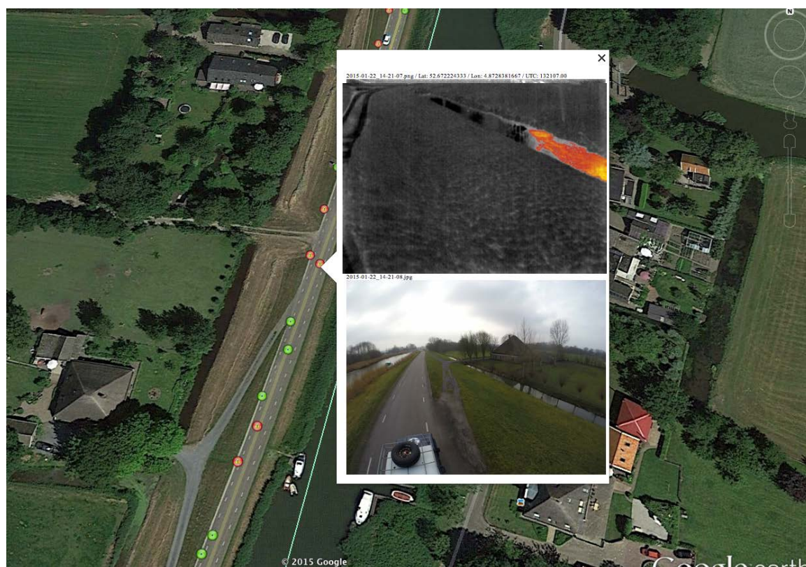
Figuur 5 Weergave infraroodmetingen ter plaatse van een kwelplek aan de polder Heerhugowaard
