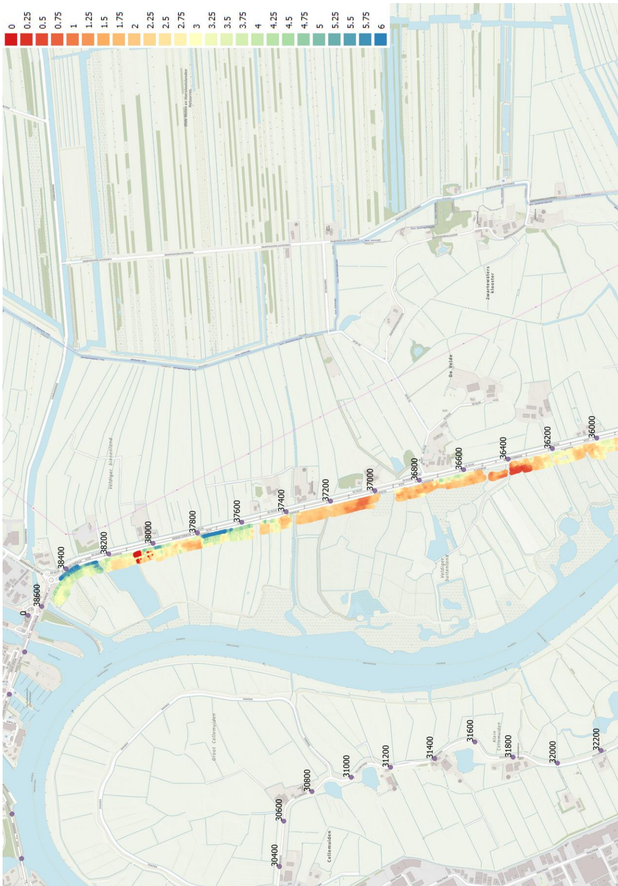
Figuur 39: Dikte deklaag voorland in [m] op basis van geofysisch onderzoek; Hasselt-Zwartsluis (2)
