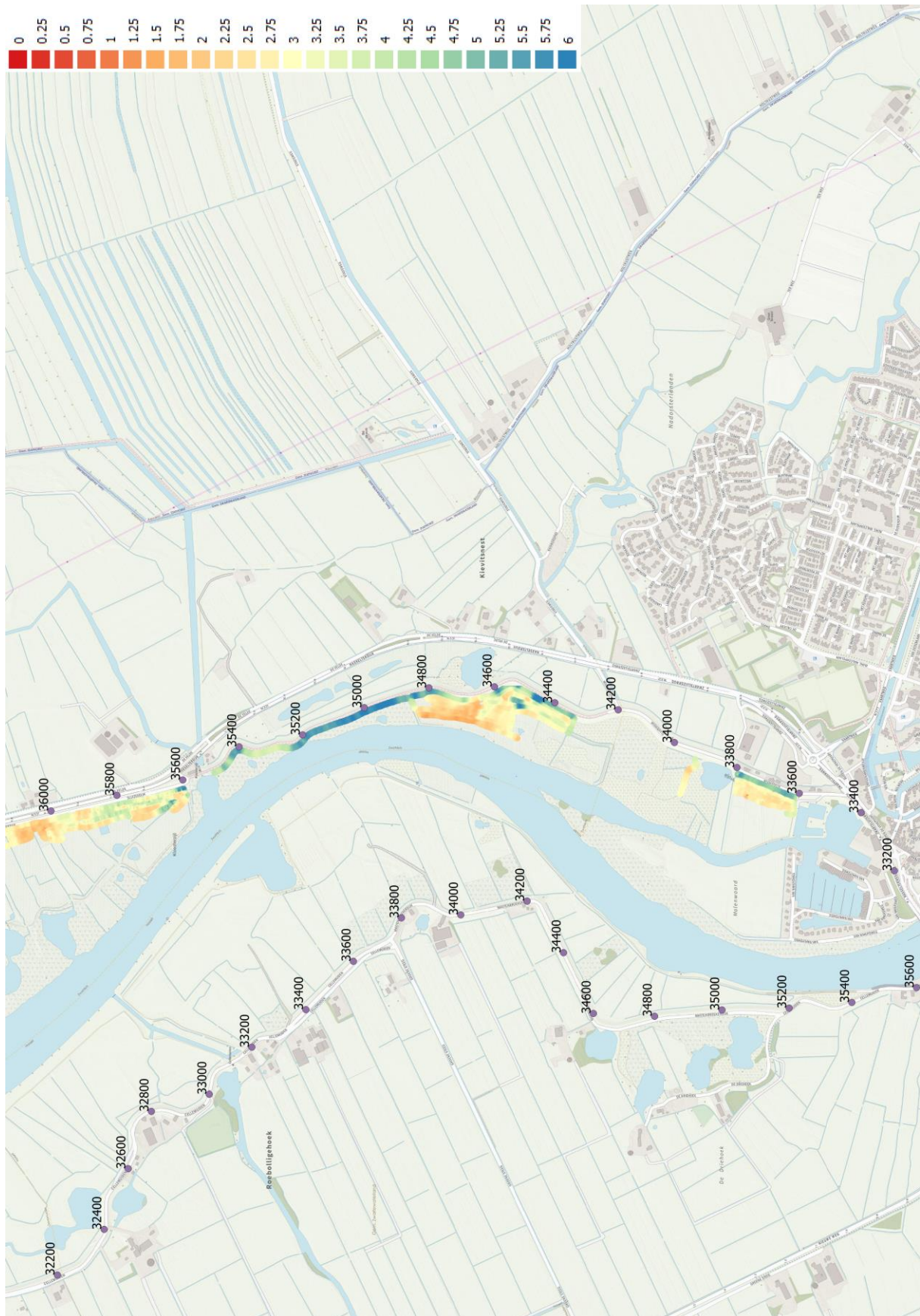
Figuur 38: Dikte deklaag voorland in [m] op basis van geofysisch onderzoek; Hasselt-Zwartsluis (1)
