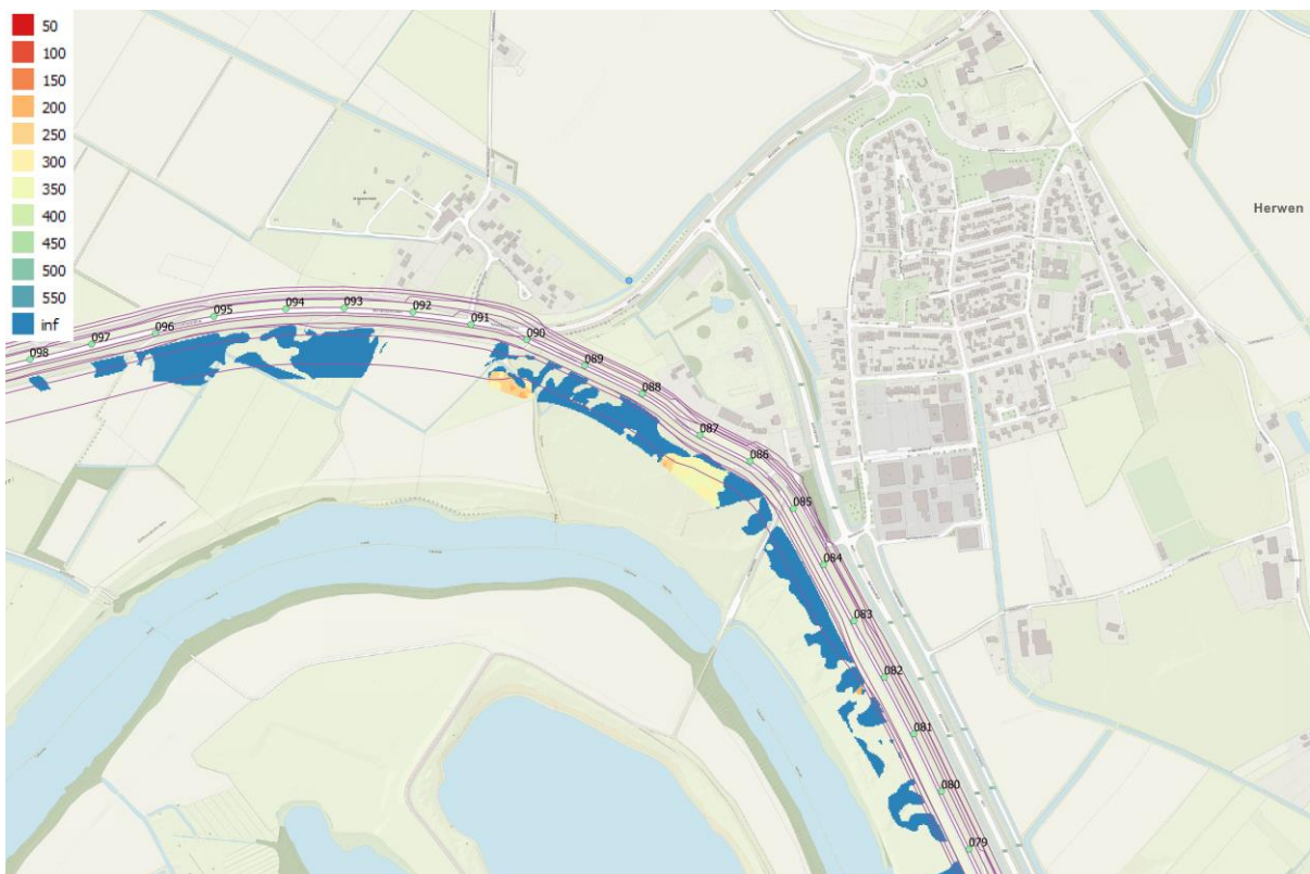
Figuur 30: Onderkant eerste kleilaag (boven) en onderkant tweede kleilaag (onder) in [cm-MV] op basis van geofysisch onderzoek; 's Gravenwaard (3)
