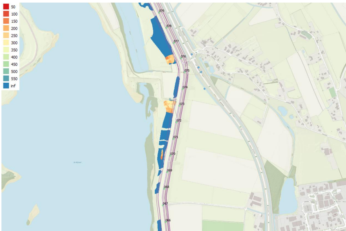
Figuur 29: Onderkant eerste kleilaag (boven) en onderkant tweede kleilaag (onder) in [cm-MV] op basis van geofysisch onderzoek; 's Gravenwaard (2)
