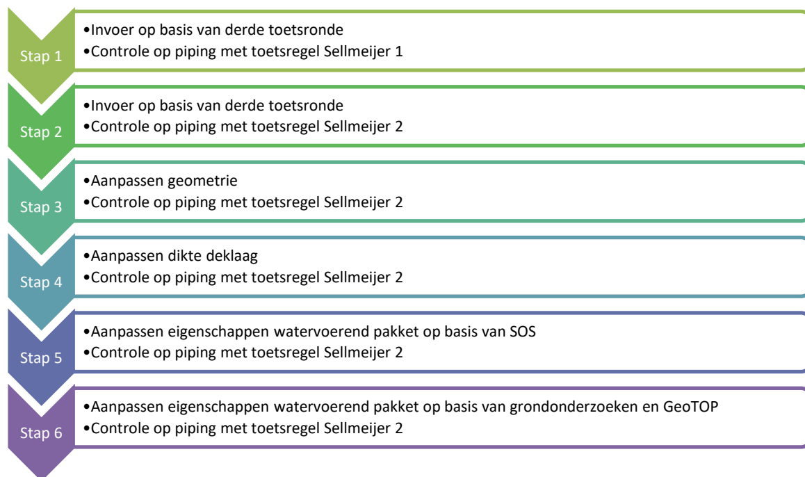
Figuur 74: Pipingberekeningen per stap
