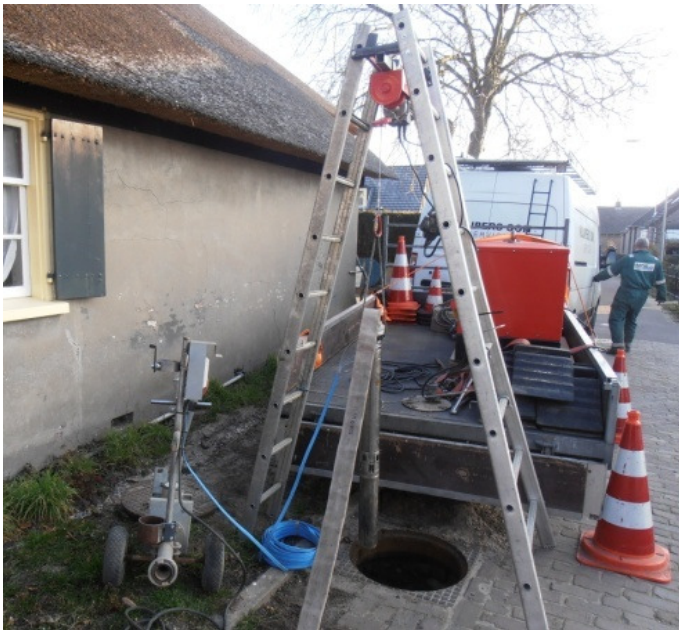
Afbeelding 4.5 Beproeving van ontlastbron Opijnen via capaciteitsproef (foto: Witteveen+Bos 2016)
