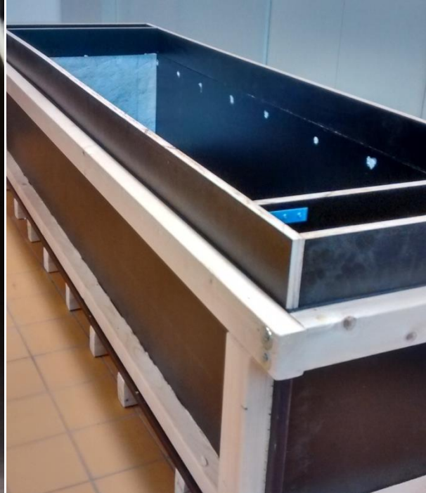
Foto 10 - Overhoogte constructie op bak
