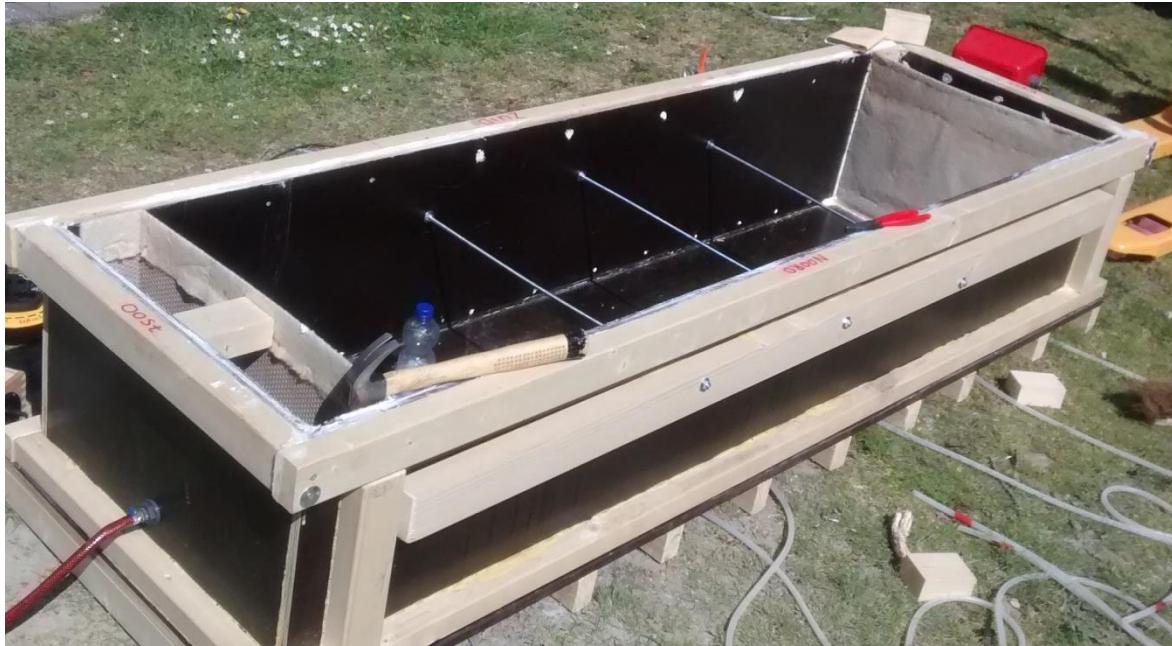
Foto 11- Proefbak met trekversteving
