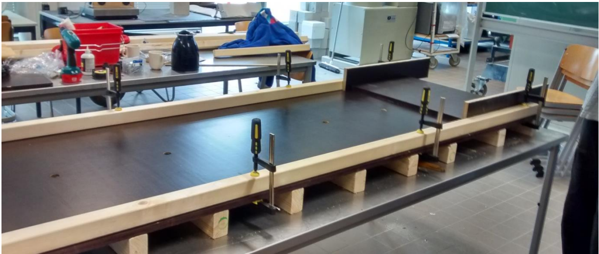
Foto 3 - Vastzetten balken onderzijde met betonplex onderdelen
