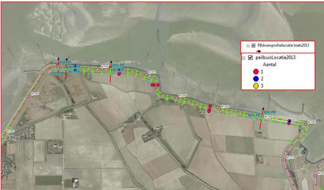
Figuur B2-1 situatie onderzoek Kop van Ossensisse tussen dp 217 en 250 met locaties van sonderingen en peilbuizen
