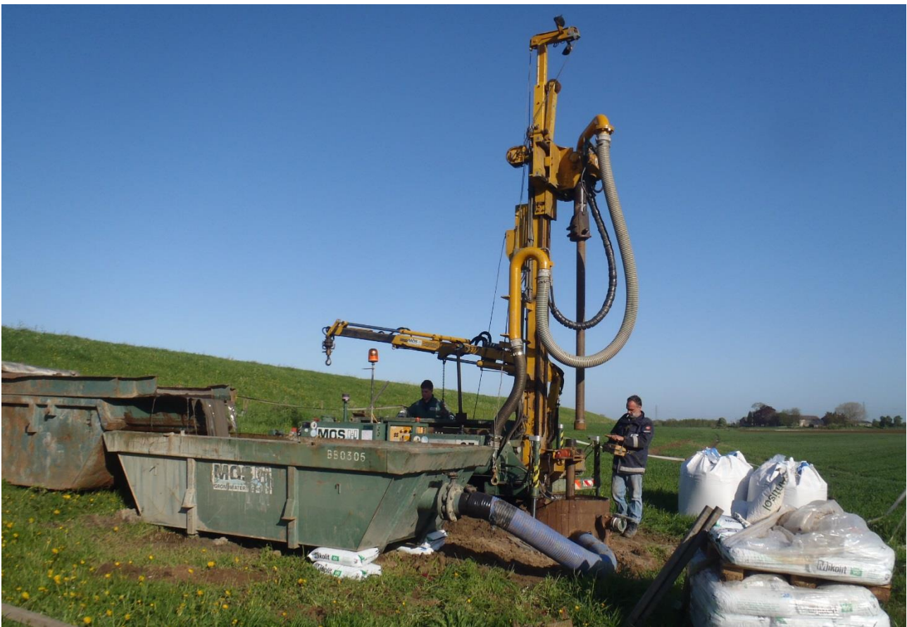
Figuur 3.1: Uitvoering van een zuigboringen ten behoeve van de pompproef bij Pannerden
