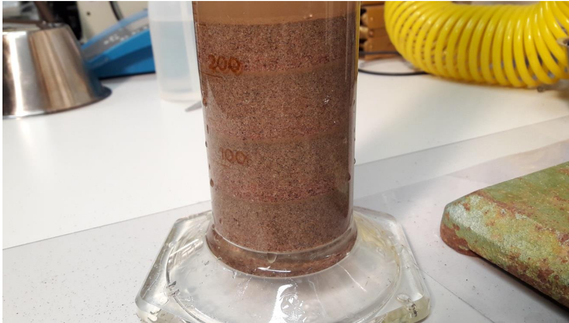
Figuur B.1 Scheiding van grove en fijne fractie door verschillen in valsnelheid (waterhoogte ca. 43 cm bij aanvang).
