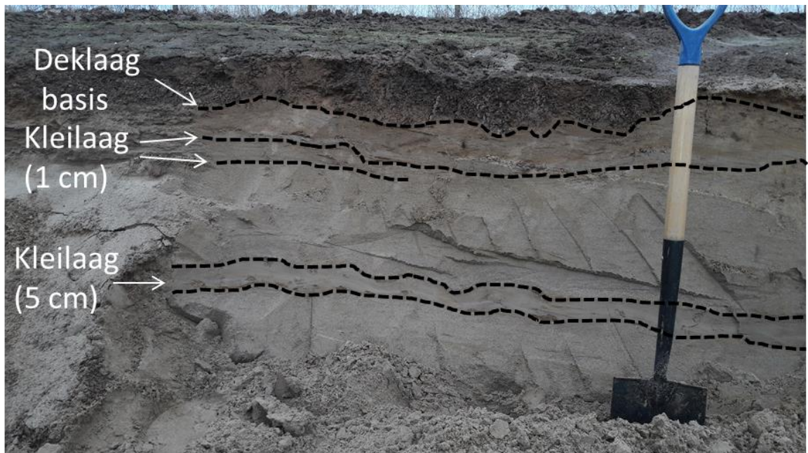
Figuur 4.19 Top van de beddingafzettingen in de uiterwaarden bij Afferden. De basis van de deklaag is zeer variabel, en in de beddingafzettingen zijn kleilaagjes aanwezig van 1 en 5 cm dik.
