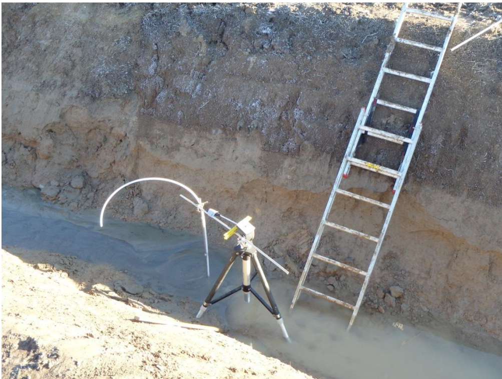
Figuur 3.10 Opstelling voor drukvalmetingen in kopsloot 2
