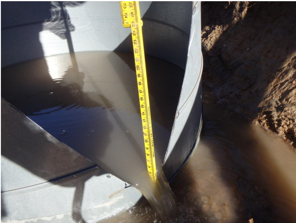
Figuur 3.11 Debietmeting aan het boorgat in kopsloot 2
