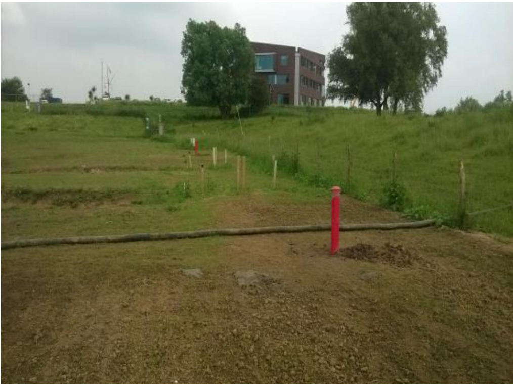
Figuur 3.15 Beide aanvullende waterspanningsmeters (rode paaltjes) nabij de uiteinden van het VZG (Bardoel, 2016)
