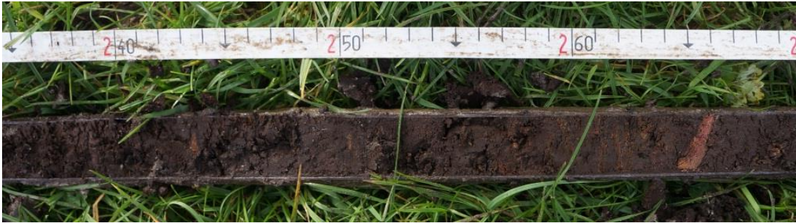
Figuur 9: Bosveen wordt gekenmerkt door aanwezigheid van stukjes hout (bruin oranje kleur op 2,66 m)
