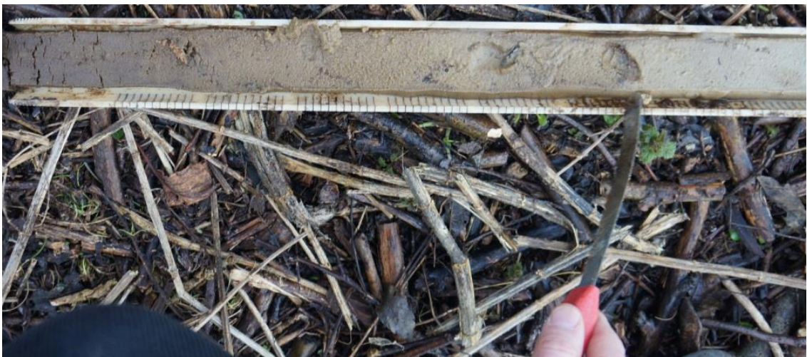
Figuur 10: Humeus bandje (circa 2,3 m –mv) met donker bruine kleur (aangeduid met spatel) in overgangszone
