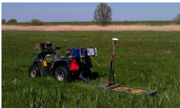
Figuur 5: quad met daaraan gemonteerd de gammaspectrometer (achter op de bagagedrager van de quad) en de grondradar (antenne achter de quad).
