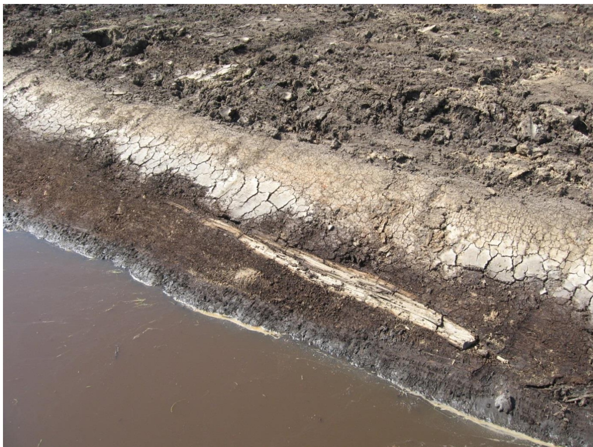
Figuur 15. Nieuw gegraven sloottalud bij Stadshagen. De bodemopbouw met klei op bosveen (met boomstam) is dan nog duidelijk te zien; enkele maanden later is het tralud weer overgroeid met grassen.
