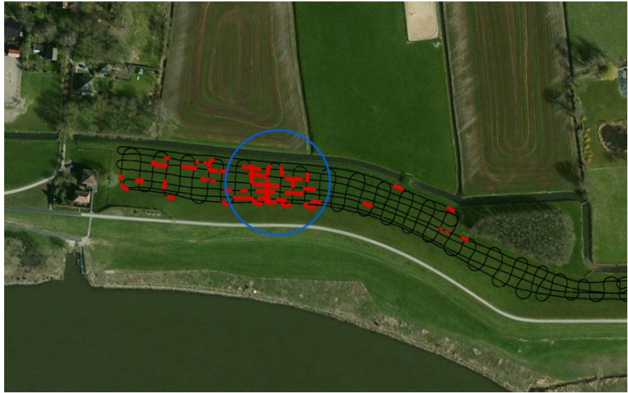
Figuur 14: meetlijnen met aangegeven anomalieën in de bodemopbouw. Binnen de blauwe cirkel is een doorlopende anomalie aangetroffen.
