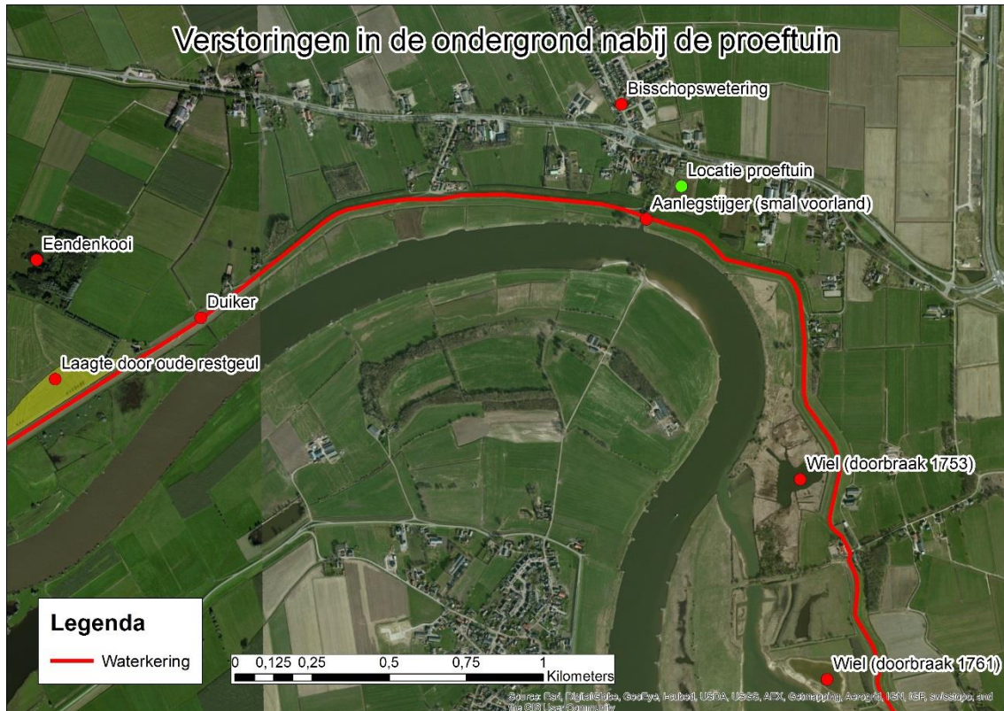
Figuur 19: Verstoringen in de ondergrond die mogelijk een risico vormen voor piping
