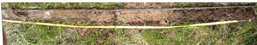
Figuur 6: foto van boring nr. 36 met rechts het maaiveld, daaronder een donkere laag klei, de laag in het midden is zandige klei, daaronder bevindt zich een deel grof zand, uiterst links grijze klei. Diepte van de boring is 195 cm -mv.
