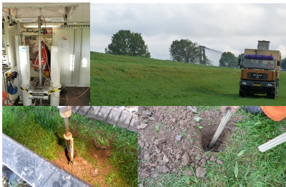
Figuur 6: Linksboven: weggedruken conus, rechtsboven: Sondeerwagen, linksonder: impressie Sonderen, rechtsonder: afdichten sondeergat
