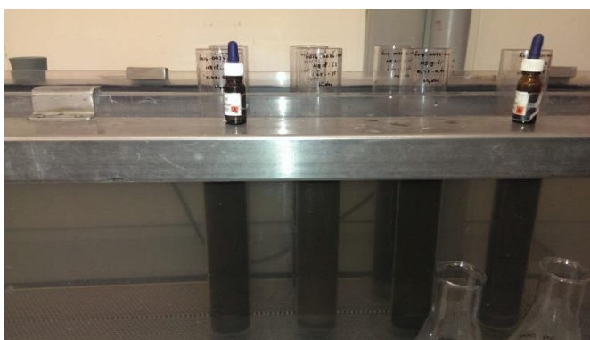
Figuur 12: Links: aerometerproef, rechts: falling head test
