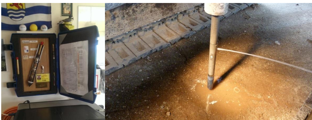
Figuur 7: Links: HPT-conus, rechts: Impressie injectie HPT-sondering,
