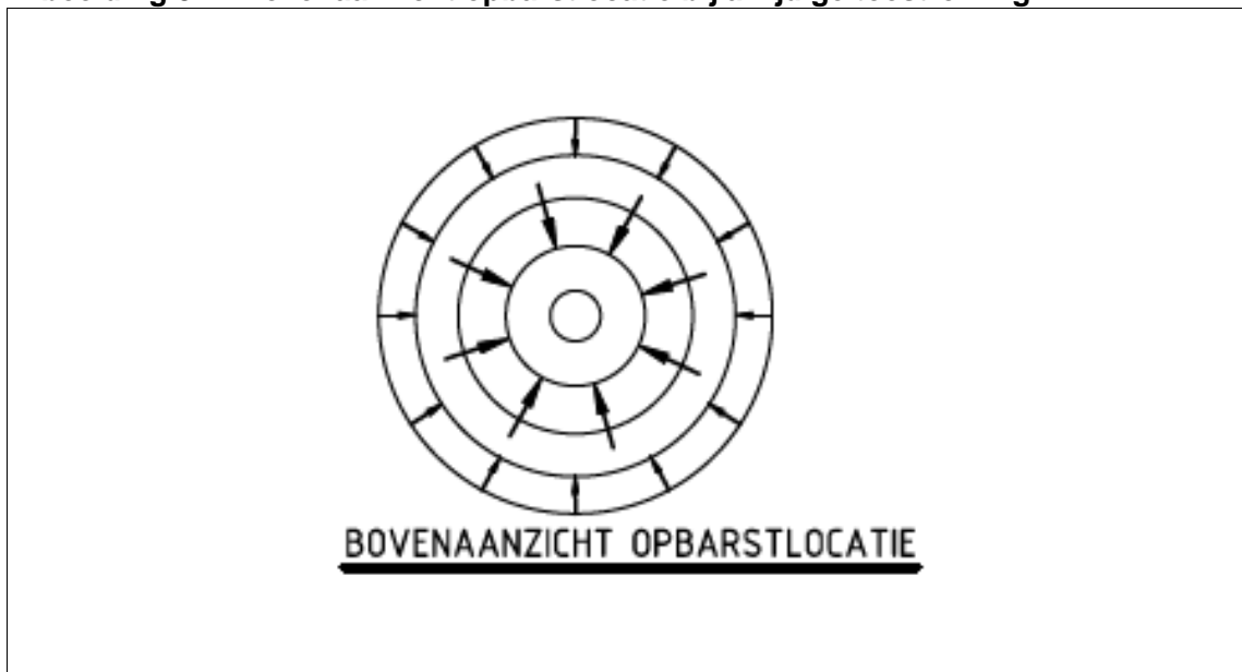
Afbeelding 8.1. Bovenaanzicht opbarstlocatie bij alzijdige toestroming
