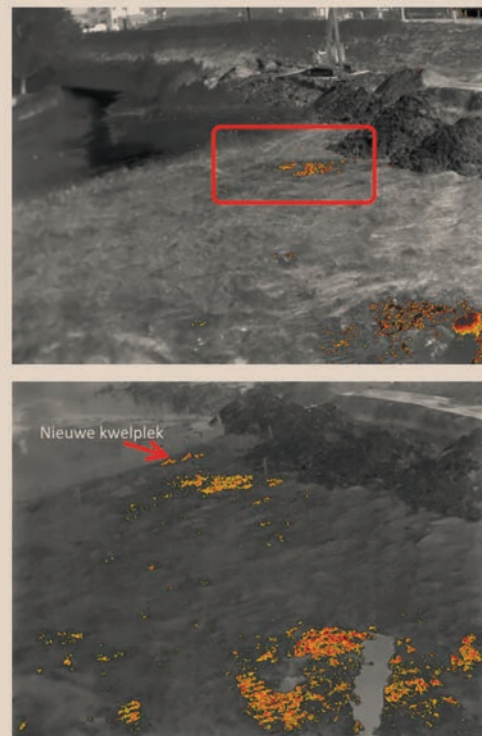
Figuur 5-1: Infraroodmeting Gouda: Infraroodbeelden laten zien dat natte plekken bij hoogwater (onder) groter zijn geworden en dat de grond aanzienlijk drassiger is geworden dan bij laagwater (boven). Dit was met blote oog niet waarneembaar (bron: VOF DijkMonitoring Nederland)
