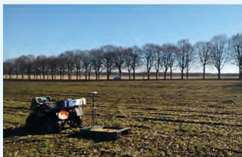
Grondradar achter een quad, klaar voor gebruik
