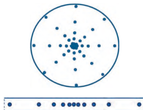
Figuur 2: Bovenaanzicht van een meetplan op één locatie waarmee de correlatielengte nauwkeurig kan worden bepaald voor bijvoorbeeld het voorland (cirkel) of een dijkteen (lijn).
