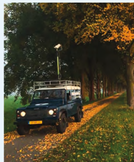
IR sensor op een terreinwagen bevestigd
