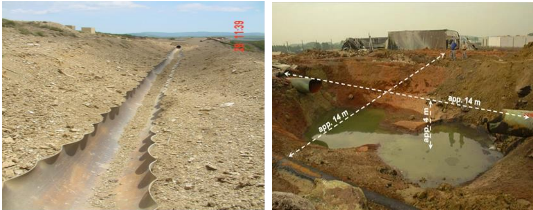
Figuur 2-3: Sleuf van een instabiele langsscheur (links) en erosiekrater van een leidingbreuk (rechts).
