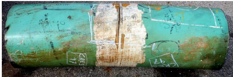
Figuur 4-3 Gescheurde las ten gevolge van buigspanningen (uit presentatie Yong-Yi Wang van CRES)
