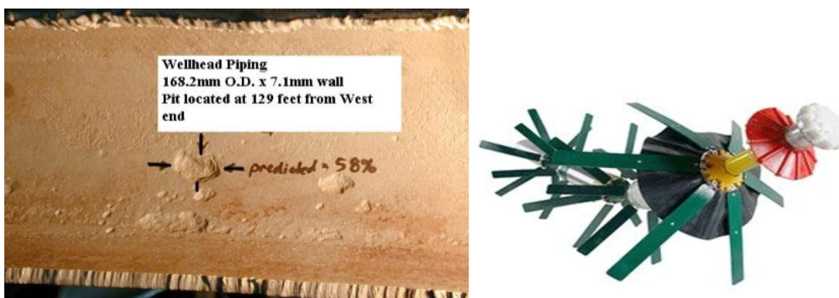
Figuur 6: Defect gedetecteerd met de See Snake
