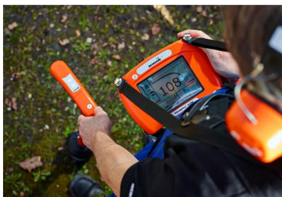
Figuur 14: Waterlekdetectie met Stethophon, bron: euro-index.nl
