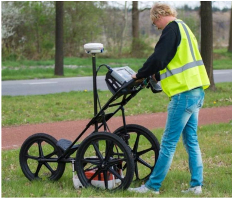
Figuur 16: Grond Radar onderzoek, (bron: Terra Carta)
