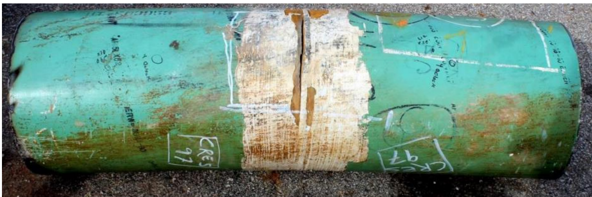
Fig.2 – Gescheurde las ten gevolge van buigspanningen (uit presentatie Yong-Yi Wang van CRES)
