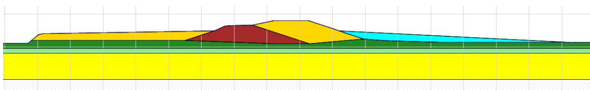
Figuur 2.3 Dwarsprofiel dijkontwerp ter plaatse van de leiding kruising (nieuw aan te leggen berm in lichtblauw)
