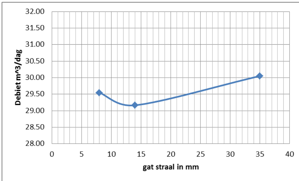
Figuur 3.5 Basisgeometrie 1: Debiet bij bezwijken als functie van de straal van het gat
